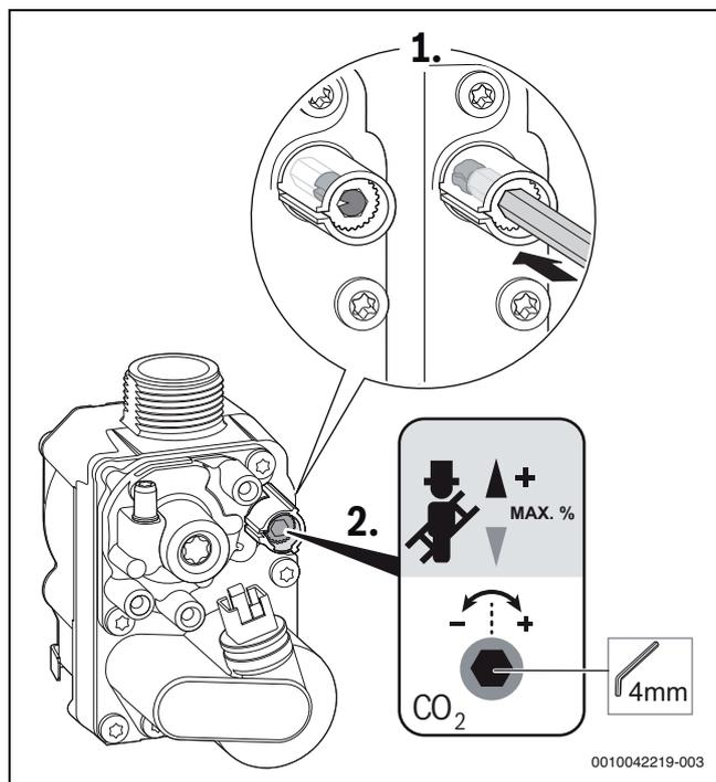
Bild 112 CO<sub>2</sub>/O<sub>2</sub>-Gehalt bei maximaler Nennwärmeleistung einstellen
