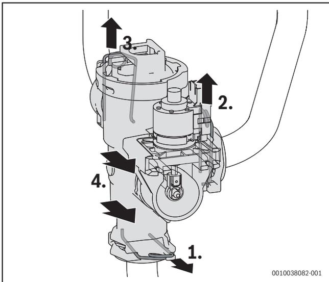
Bild 162 Federn lösen
