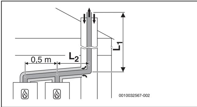
Bild 47 Kaskade mit 2 Geräten:
