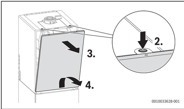
Bild 118 Vorderteil der Geräteverkleidung abnehmen
