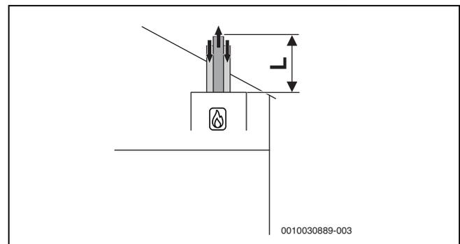
Bild 30 Vertikale konzentrische Luft-Abgas-Führung nach C<sub>33x</sub>
