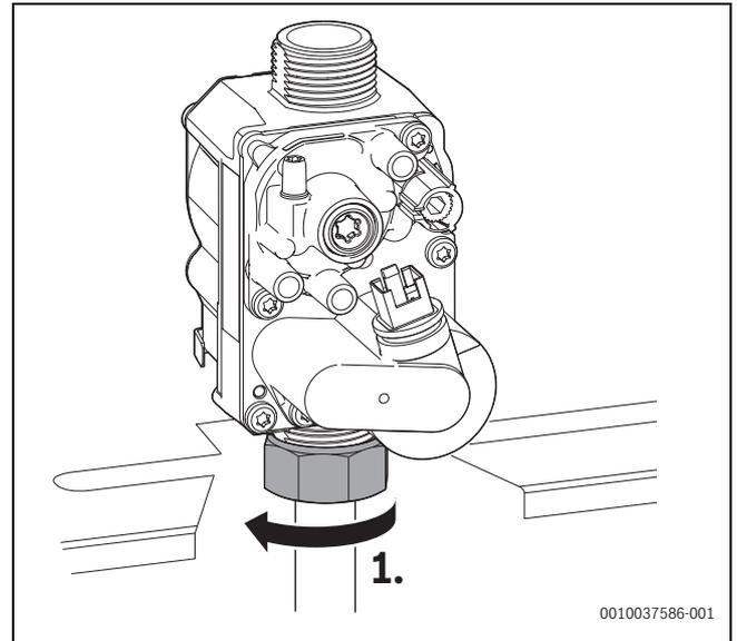
Bild 146 Überwurfmutter lösen
