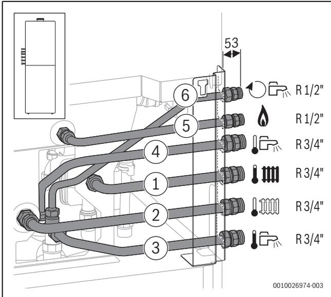
Bild 55 Zubehör CS 10 auf der linken Seite montiert
