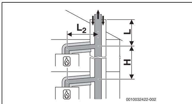
Bild 44 Mehrfachbelegung nach C<sub>(14)3x</sub> mit kollektiver starrer Abgasführung und konzentrischer Luft-Abgas-Führung im Aufstellraum[L<sub>2</sub>] ≤ 1,4 m
