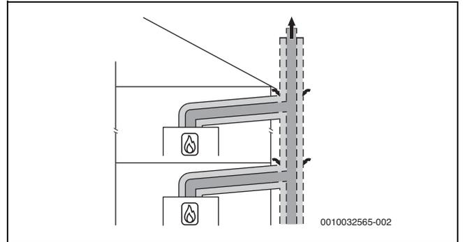
Bild 42 Mehrfachbelegung nach C<sub>(12)3x</sub> mit konzentrischer Luft-Abgas-Führung im Aufstellraum
