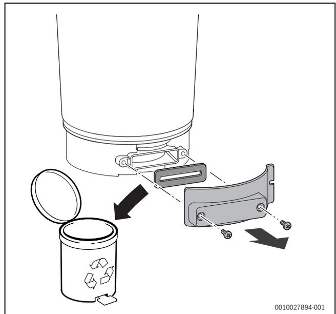
Bild 135 Prüföffnung öffnen
