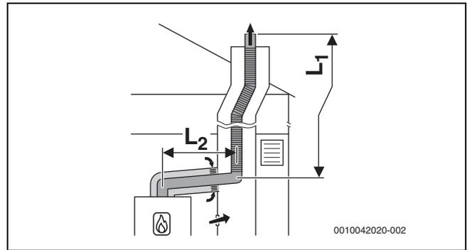
Bild 40 Flexible Abgasführung im Schacht nach B<sub>53p</sub>/B<sub>53s</sub> mit raumluftabhängiger Luftzufuhr über die konzentrische Luft-Abgas-Führung im Aufstellraum
