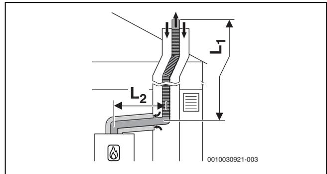
Bild 36 Flexible Abgasführung nach C<sub>93x</sub> im Schacht und konzentrische Luft-Abgas-Führung im Aufstellraum
