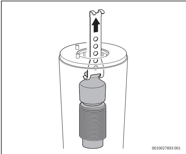
Bild 130 Oberen Verdrängungskörper herausnehmen
