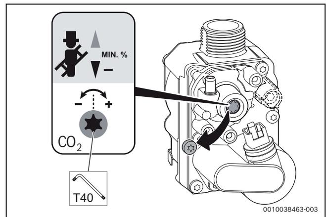
Bild 113 CO<sub>2</sub>/O<sub>2</sub>-Gehalt bei minimaler Nennwärmeleistung einstellen
