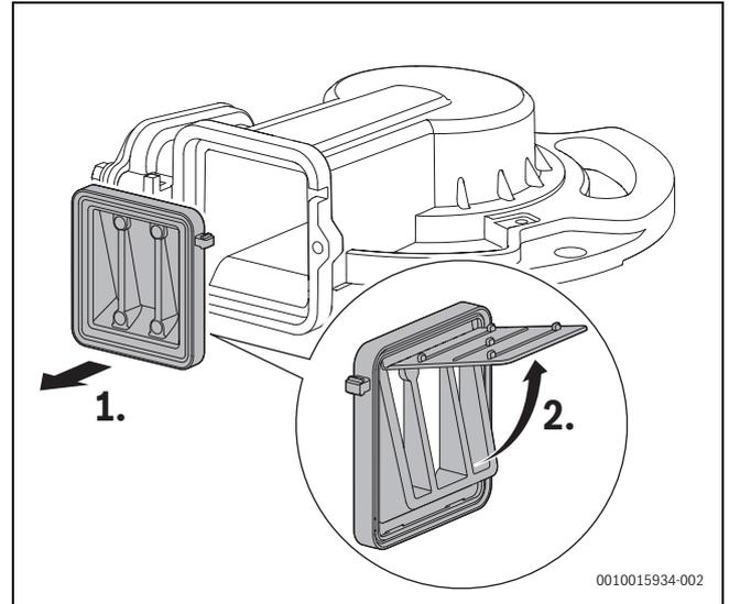
Bild 128 Rückströmsicherung in der Mischeinrichtung
