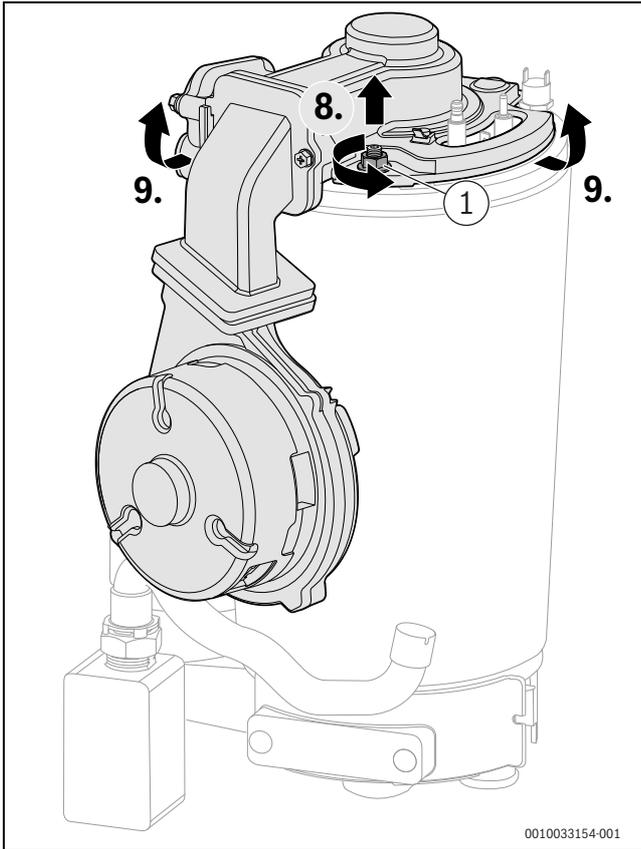
Bild 126 Brennerdeckel mit Gebläse und Mischeinrichtung abnehmen
