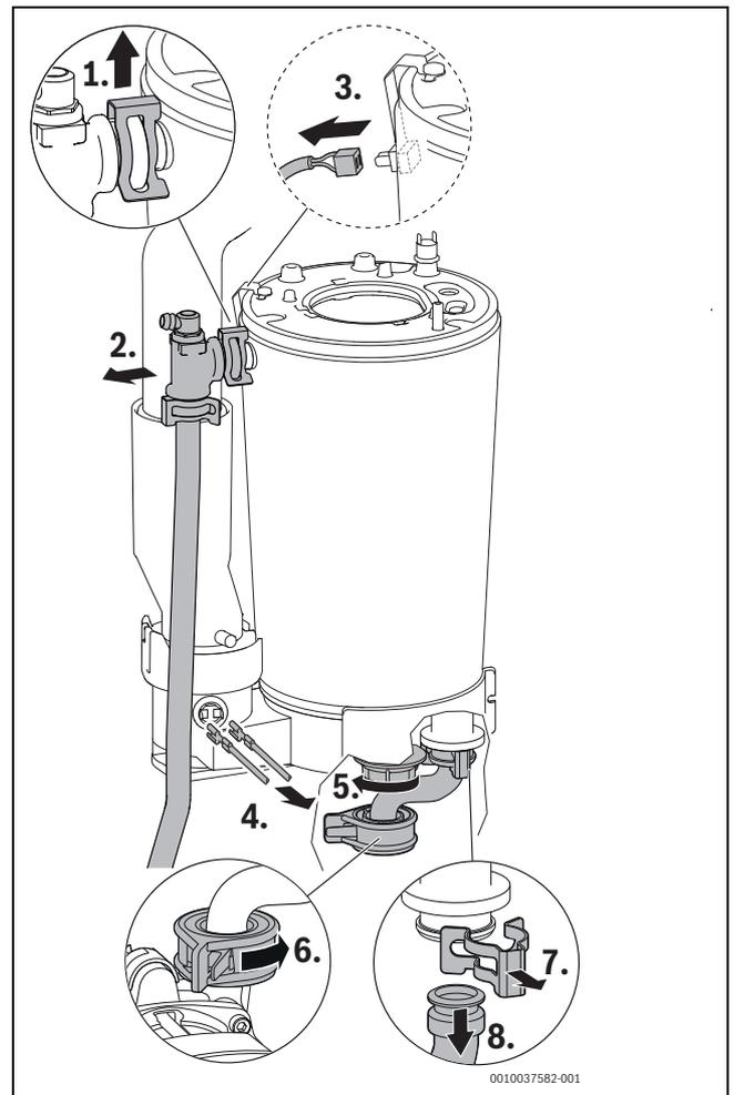
Bild 138 Vorlaufrohr lösen, Kabel abziehen und Rücklaufrohr lösen
