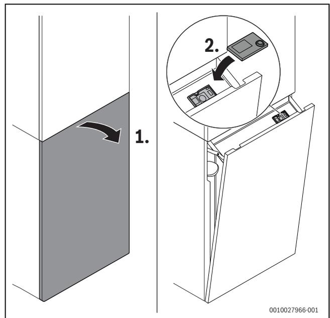
Bild 79 Bedieneinheit Logamatic RC310 einsetzen
