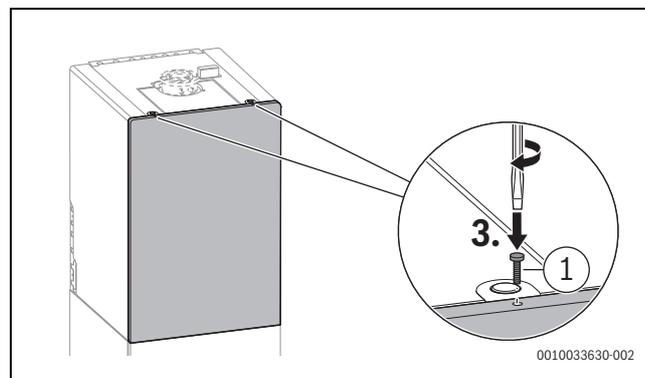
Bild 99 Vorderteil der Geräteverkleidung mit Schraube aus Lieferumfang sichern
