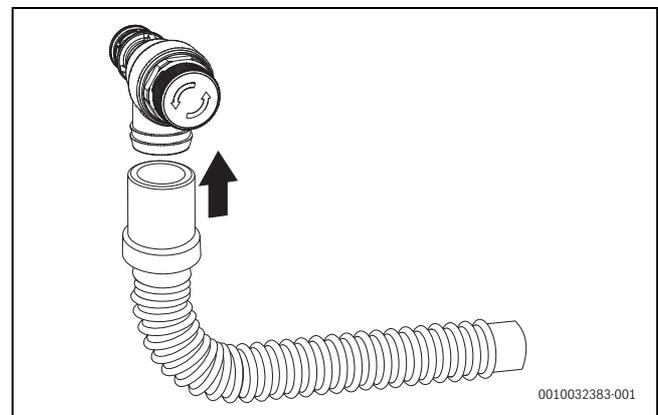
Bild 73 Schlauch am Sicherheitsventil (Heizung) montieren
