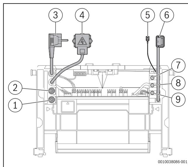
Bild 87 Lieferzustand des Steuergeräts mit angeschlossenen Komponenten
