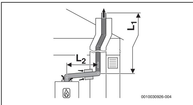
Bild 39 Flexible Abgasführung im Schacht nach B<sub>53p</sub> mit raumluftabhängiger Luftzufuhr am Gerät und konzentrischem Verbindungsstück zwischen Aufstellraum und Schacht
