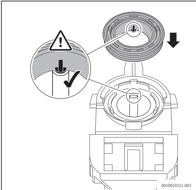
Bild 154 Neue Dichtung am Kondensatsiphon ausrichten
