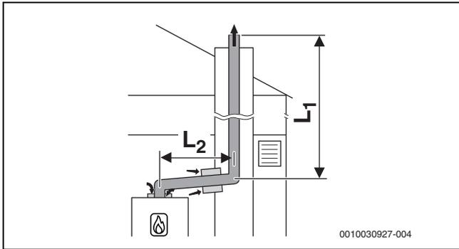
Bild 37 Starre Abgasführung im Schacht nach B<sub>53p</sub> mit raumluftabhängiger Luftzufuhr am Gerät und konzentrischem Verbindungsstück zwischen Aufstellraum und Schacht
