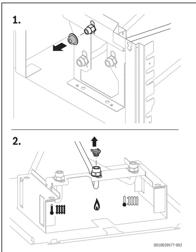
Bild 58 Schutzkappe und Stopfen am Gasrohr entfernen
