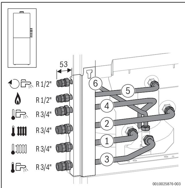
Bild 56 Zubehör CS 10 auf der rechten Seite montiert
