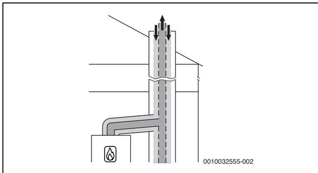
Bild 31 Konzentrische Luft-Abgas-Führung nach C<sub>43x</sub> im Aufstellraum
