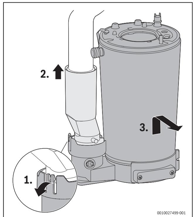
Bild 139 Wärmeblock ausbauen
