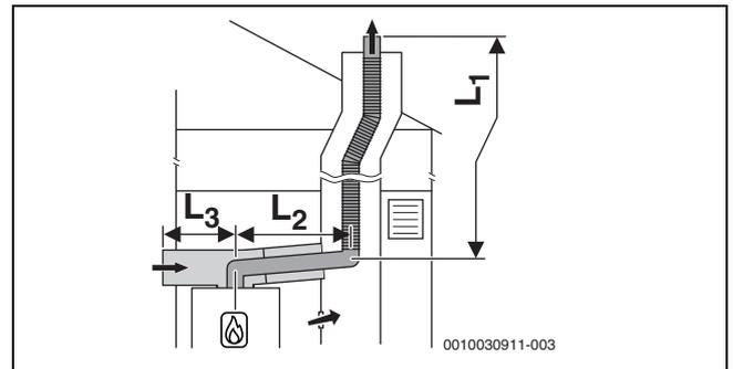
Bild 33 Flexible Abgasführung nach C<sub>53x</sub> im Schacht und Luft-Abgas-Führung mit separater Luftzufuhr und konzentrischer Abgasableitung im Aufstellraum
