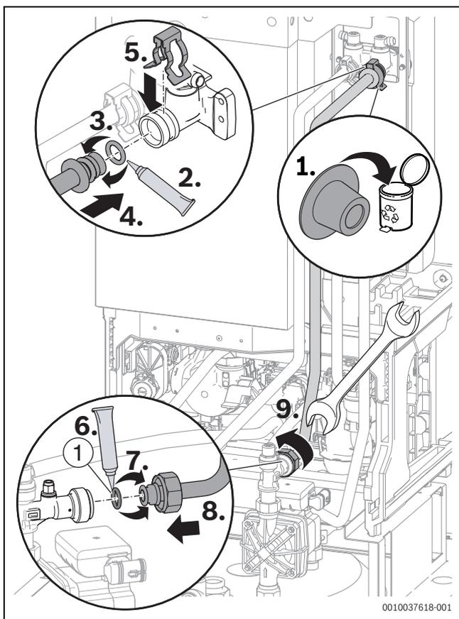
Bild 66 Kaltwasserrohr des Speicherladekreises anschließen
