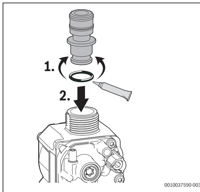
Bild 150 Gasdüse einsetzen
