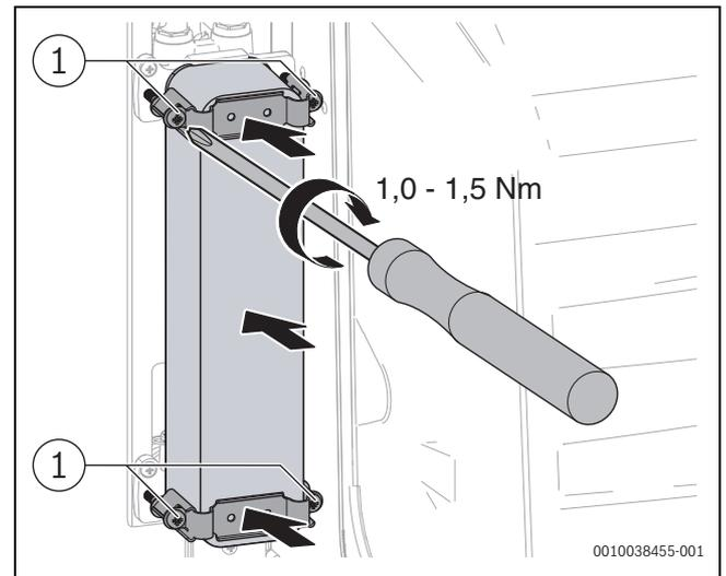
Bild 160 Plattenwärmetauscher einbauen
