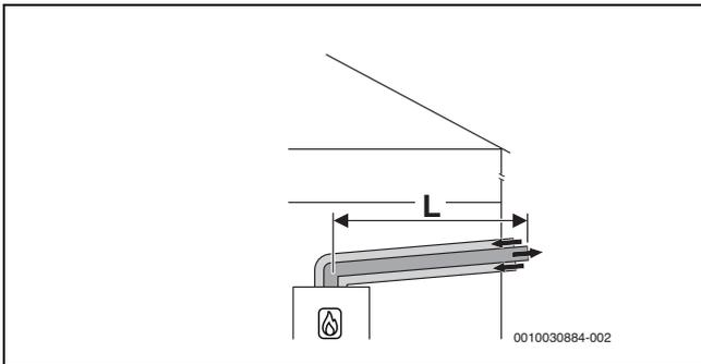
Bild 27 Horizontale konzentrische Luft-Abgas-Führung nach C<sub>13x</sub> durch die Außenwand
