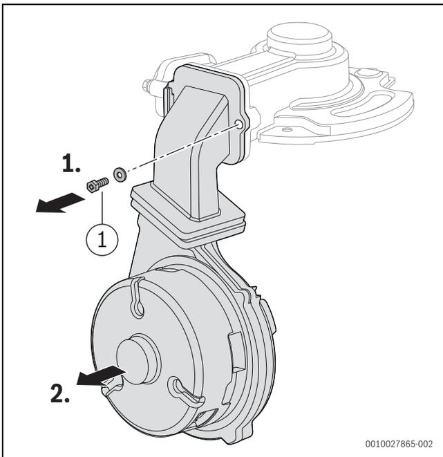
Bild 127 Mischeinrichtung und Gebläse ausbauen
