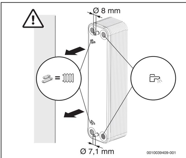
Bild 159 Position des Plattenwärmetauschers prüfen
