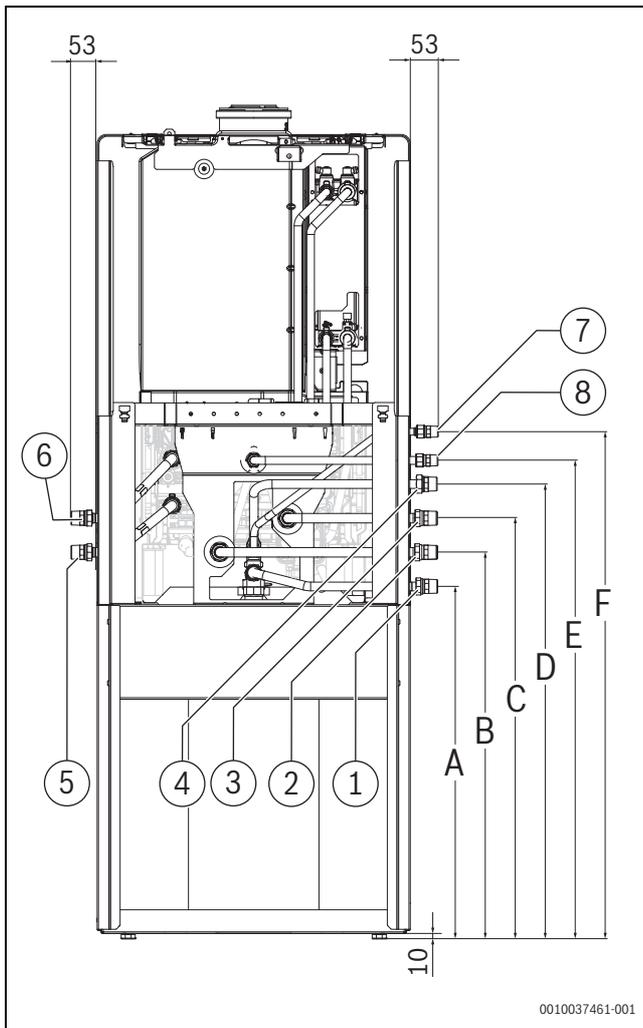
Bild 15 Ansicht von der Rückseite (Maße in mm)
