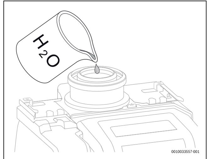
Bild 76 Kondensatsiphon mit Wasser füllen
