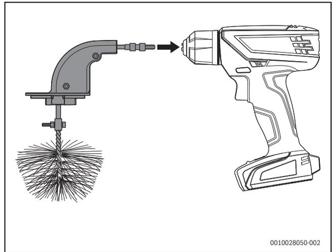
Bild 133 Bürste mit Akku-Schrauber verbinden
