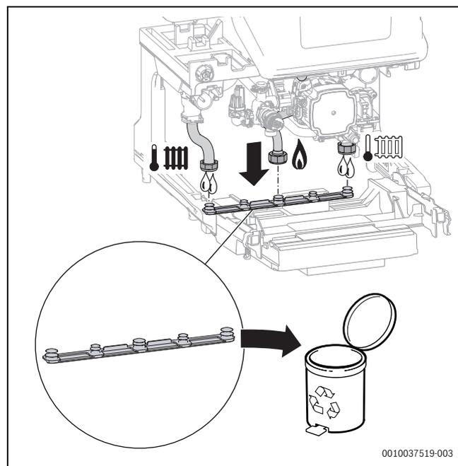
Bild 60 Stopfen am Heizungsvorlauf, Gas, Heizungsrücklauf entfernen
