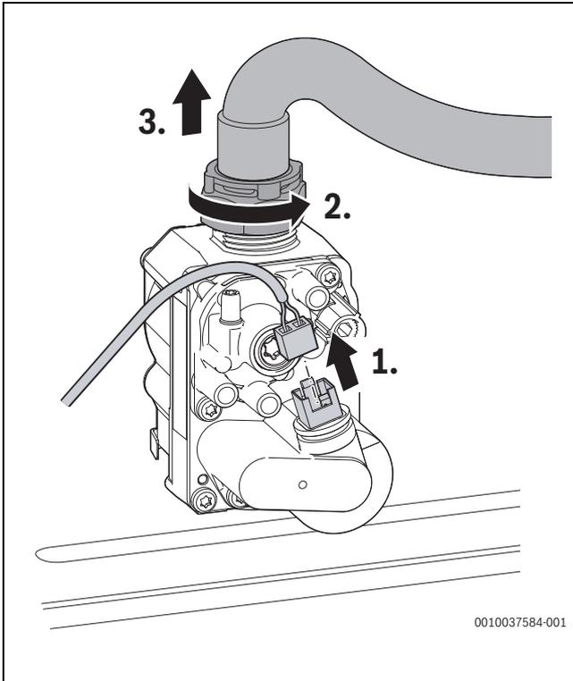
Bild 144 Stecker an der Gasarmatur abziehen und Überwurfmutter mit Gasschlauch abnehmen
