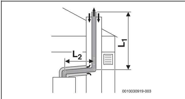
Bild 35 Starre Abgasführung nach C<sub>93x</sub> im Schacht und konzentrische Luft-Abgas-Führung im Aufstellraum
