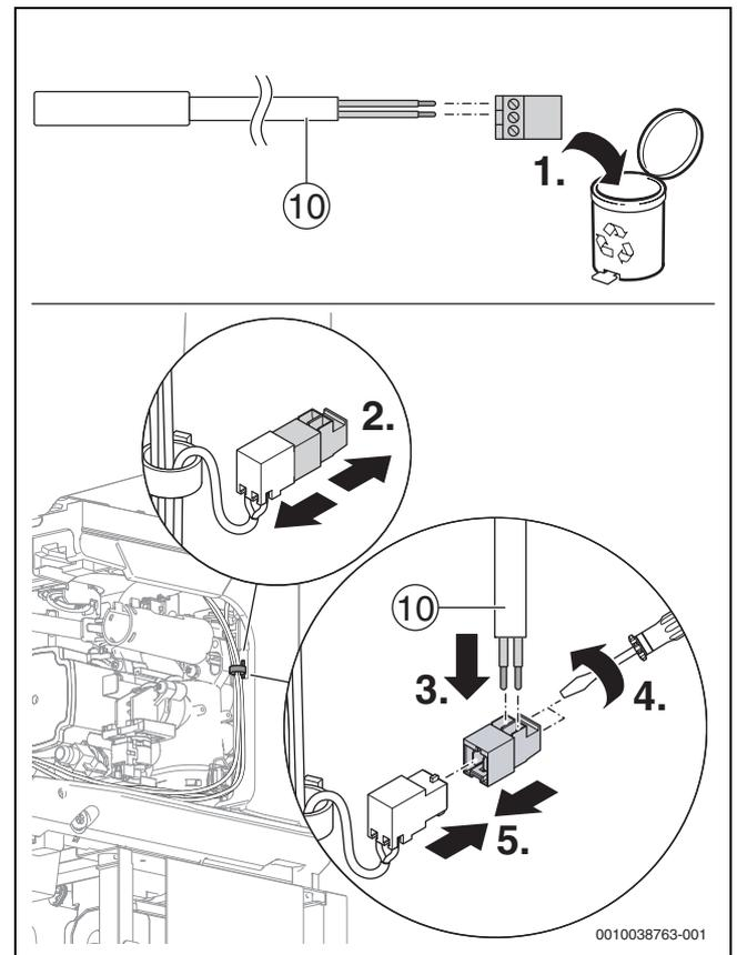
Bild 93 Pufferspeicher-Temperaturfühler anschließen
