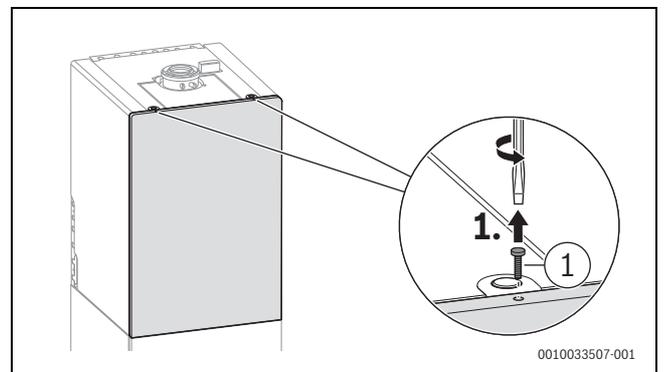
Bild 117 Sicherungsschraube lösen
