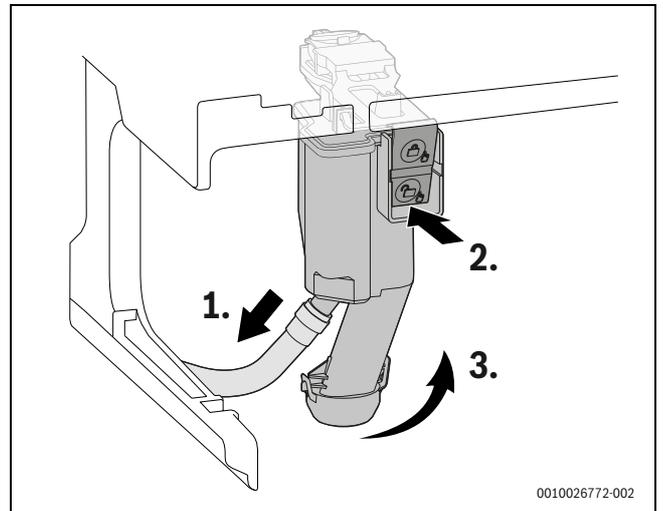
Bild 153 Kondensatsiphon ausbauen
