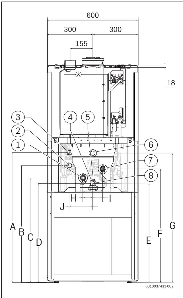
Bild 19 Ansicht von der Rückseite (Maße in mm)
