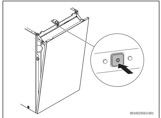
Bild 116 Gerät am Schalter Ein/Aus einschalten
