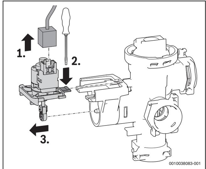
Bild 163 Motor aus dem Gehäuse herausnehmen.
