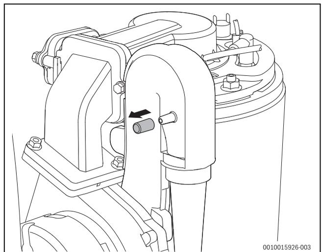
Bild 121 Messstutzen an der Mischeinrichtung
