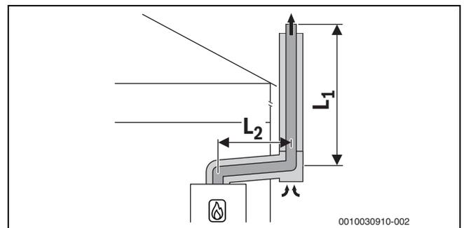
Bild 34 Konzentrische Luft-Abgas-Führung nach C<sub>53x</sub> an der Außenwand
