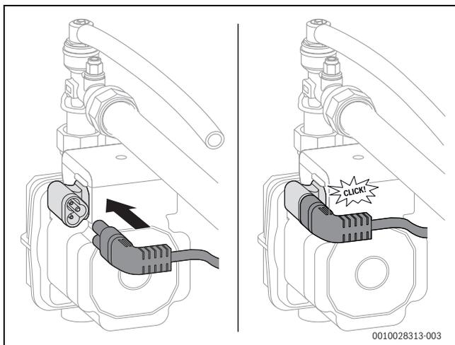
Bild 92 Schichtladepumpe elektrisch anschließen
