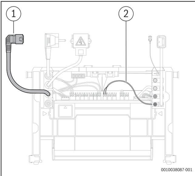
Bild 88 Steckplatz für Schichtladepumpe und Anschluss des Warmwasserspeicher-Temperaturfühlers
