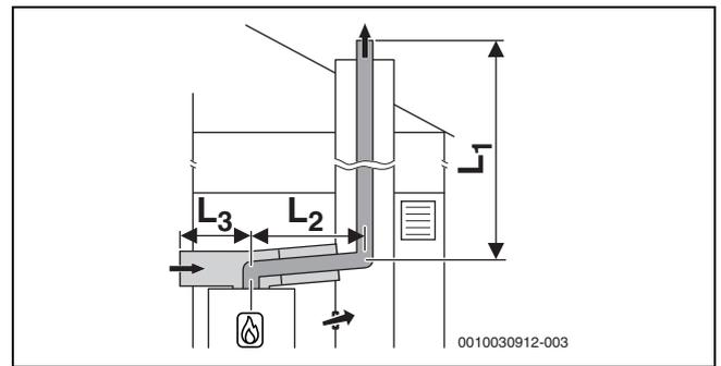
Bild 32 Starre Abgasführung nach C<sub>53x</sub> im Schacht und Luft-Abgas-Führung mit separater Luftzufuhr und konzentrischer Abgasableitung im Aufstellraum
