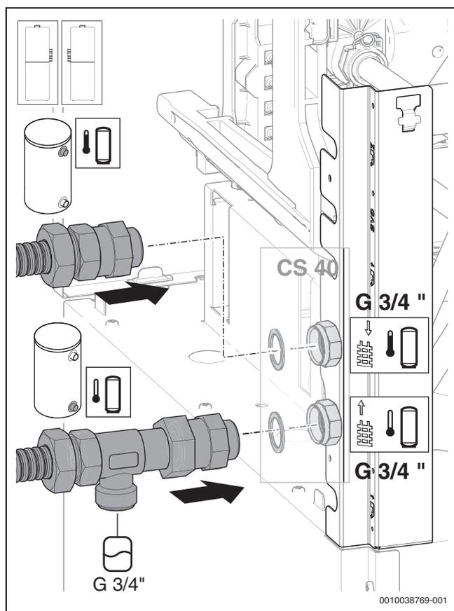
Bild 51 Ausdehnungsgefäß anschließen
