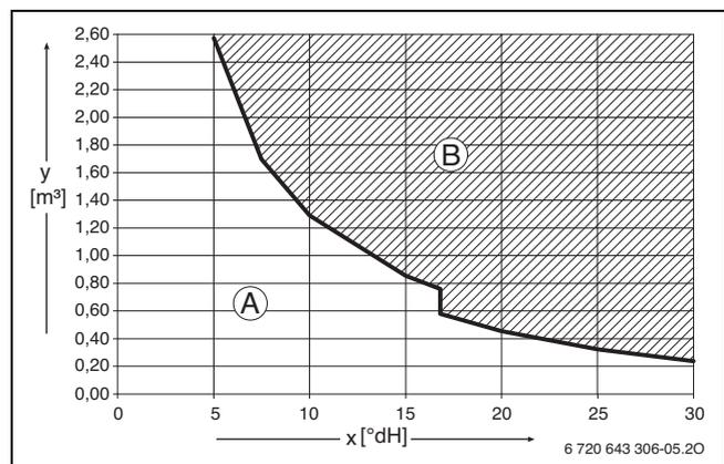
Bild 49 Anforderungen an Füll- und Ergänzungswasser Geräte < 50 kW
