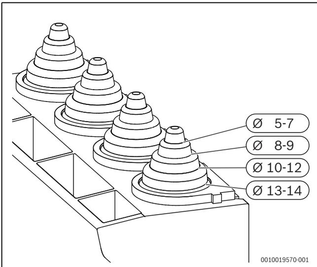
Bild 89 Zugentlastung an Kabeldurchmesser anpassen
