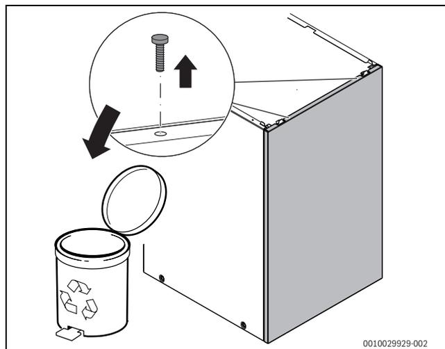
Bild 54 Transportsicherung am Vorderteil der Speicherverkleidung entfernen
