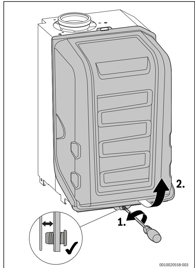
Bild 109 Brennerhaube abnehmen
