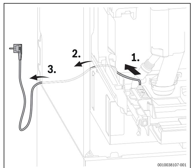
Bild 94 Kabelführung des Netzkabels
