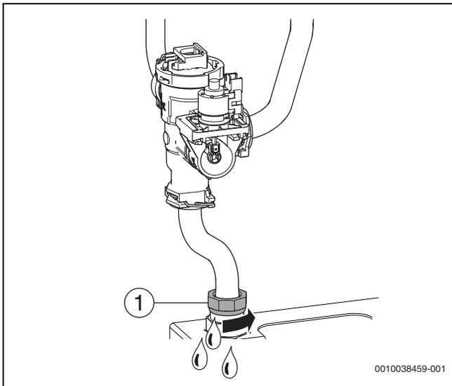
Bild 161 Wasser aus dem Wärmetauscher ablassen
