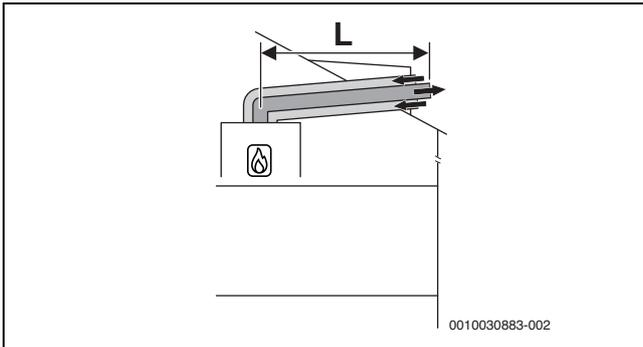
Bild 28 Horizontale konzentrische Luft-Abgas-Führung nach C<sub>13x</sub> über das Dach
