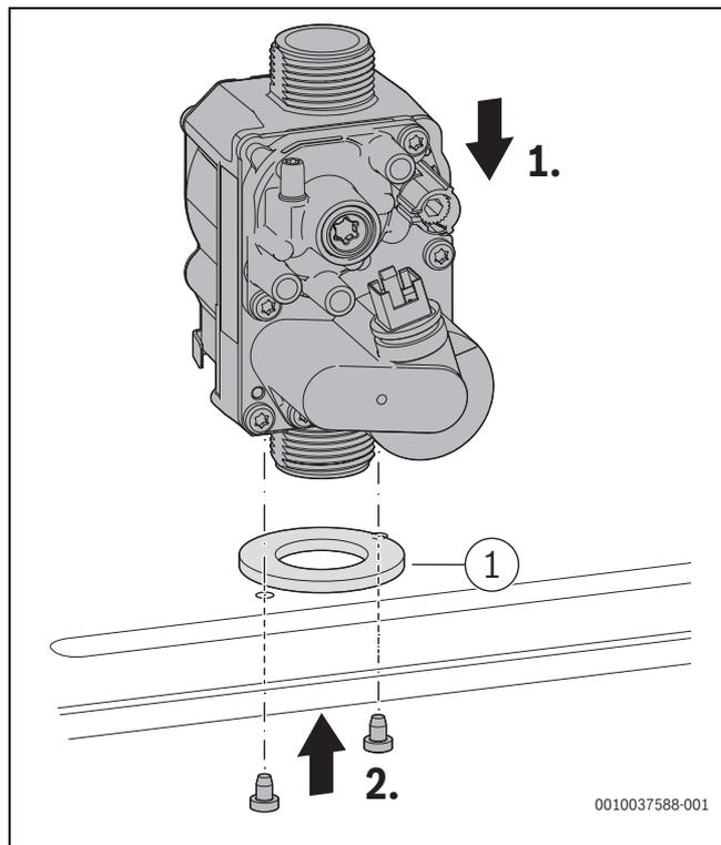
Bild 148 Gasarmatur einbauen
