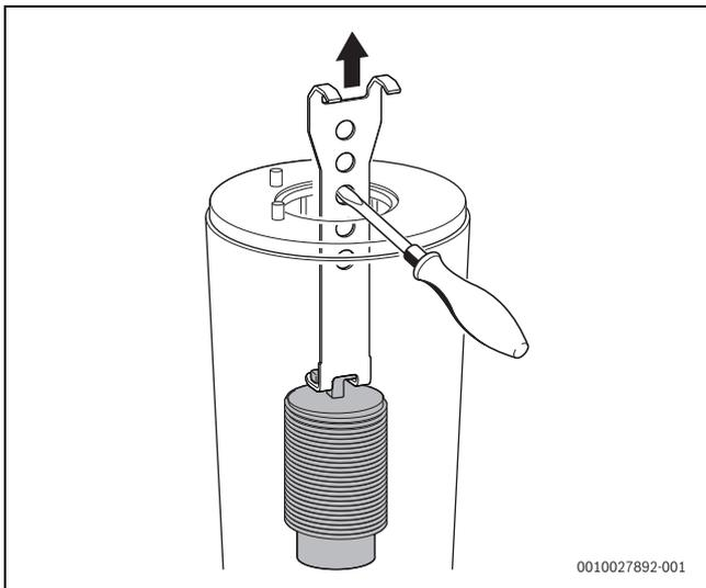
Bild 131 Unteren Verdrängungskörper herausnehmen
