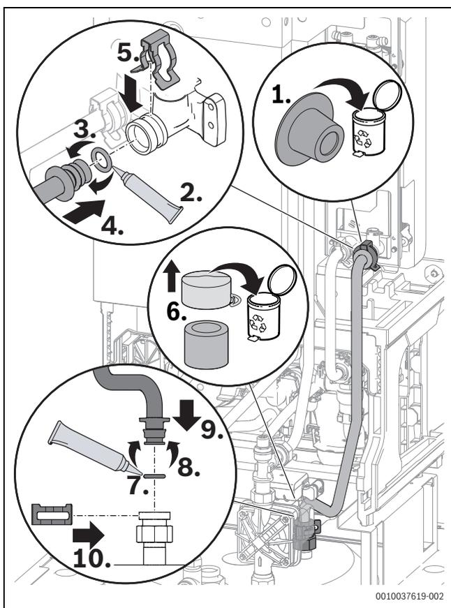
Bild 67 Warmwasserrohr des Speicherladekreises am Speicher anschließen
