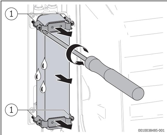
Bild 158 Plattenwärmetauscher ausbauen
