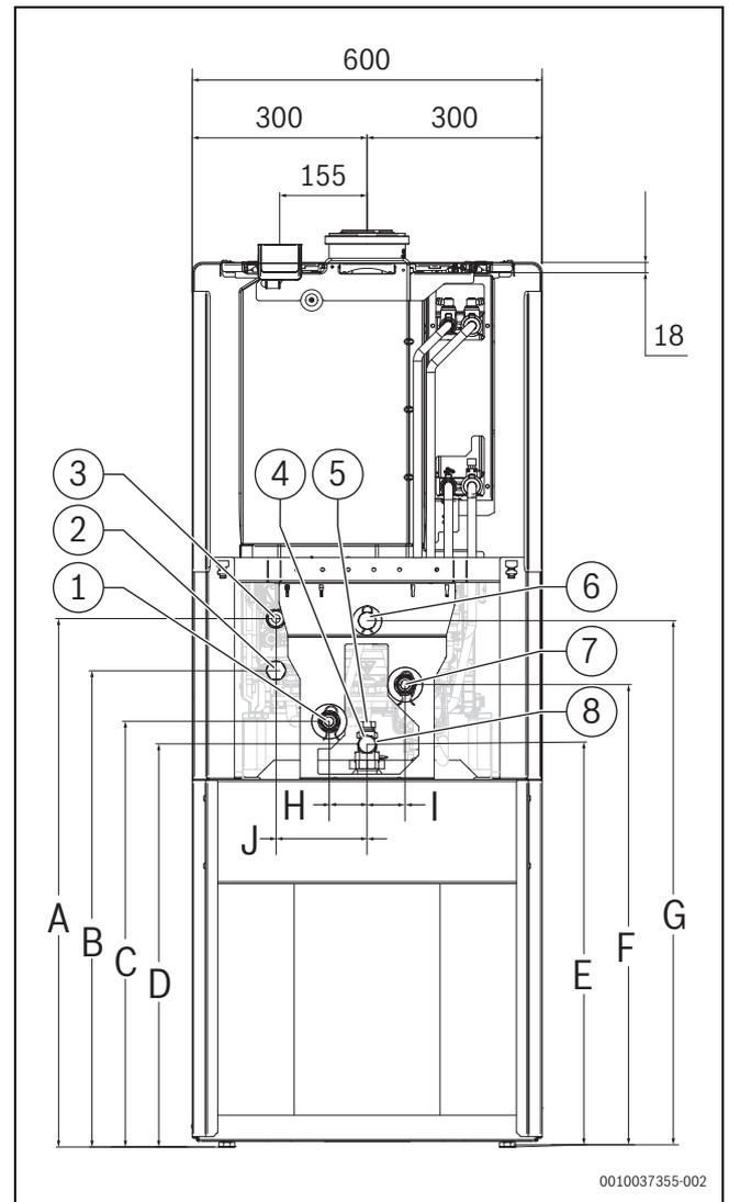
Bild 12 Ansicht von der Rückseite (Maße in mm)
