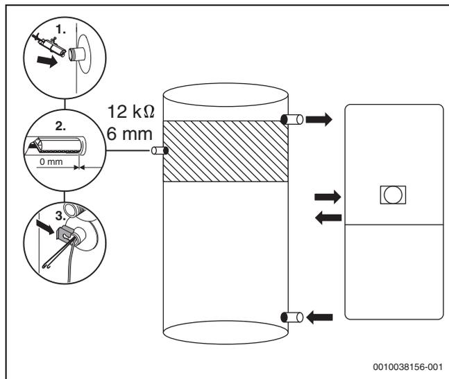
Bild 78 Pufferspeicher-Temperaturfühler einsetzen
