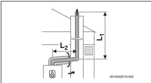
Bild 38 Starre Abgasführung im Schacht nach B<sub>53p</sub>/B<sub>53s</sub> mit raumluftabhängiger Luftzufuhr über die konzentrische Luft-Abgas-Führung im Aufstellraum
