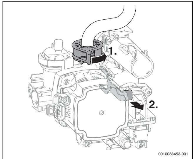
Bild 142 Heizungspumpe entriegeln
