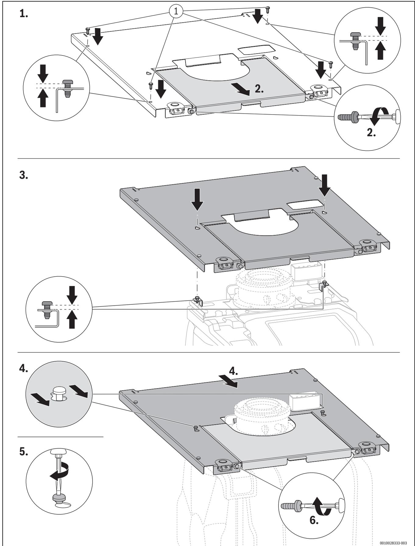
Bild 95 Oberteile der Geräteverkleidung befestigen. Wenn erforderlich können beide Teile der Verkleidung nacheinander eingesetzt werden.
