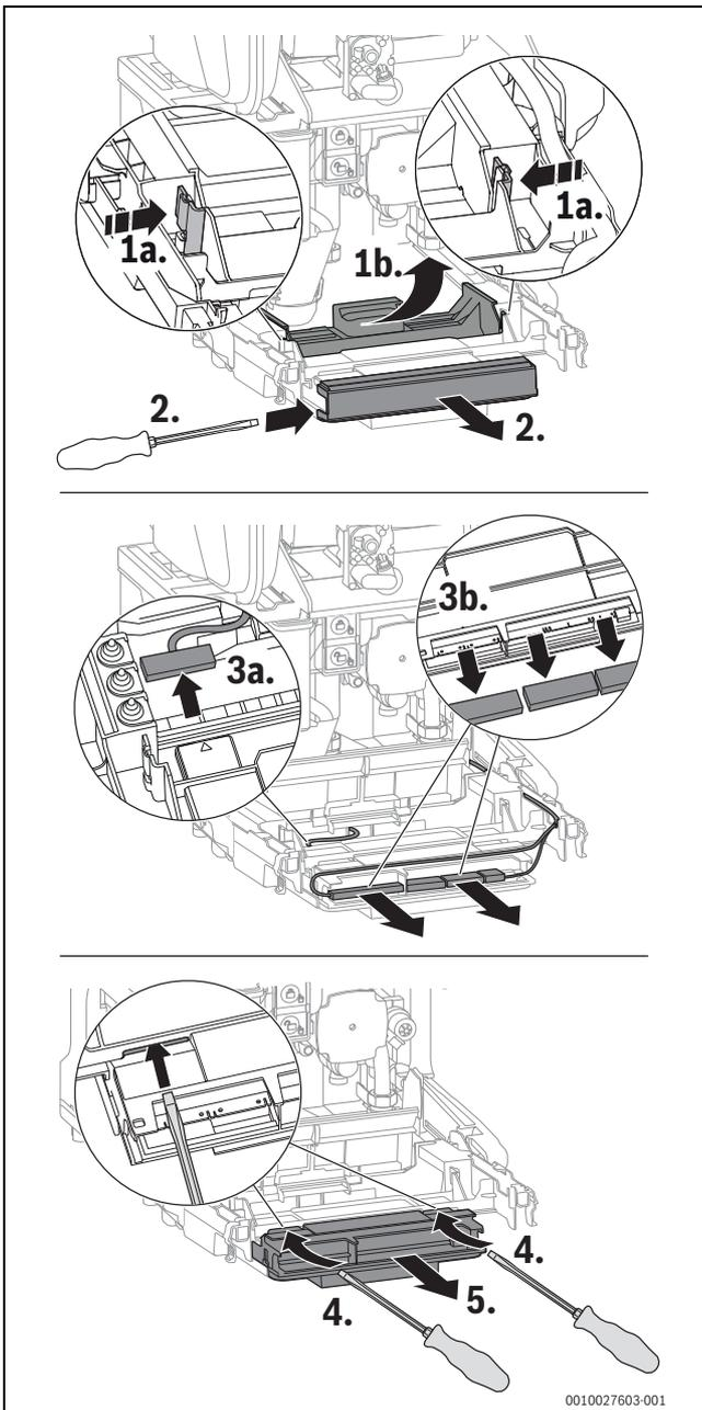
Bild 152 Steuergerät herausnehmen
