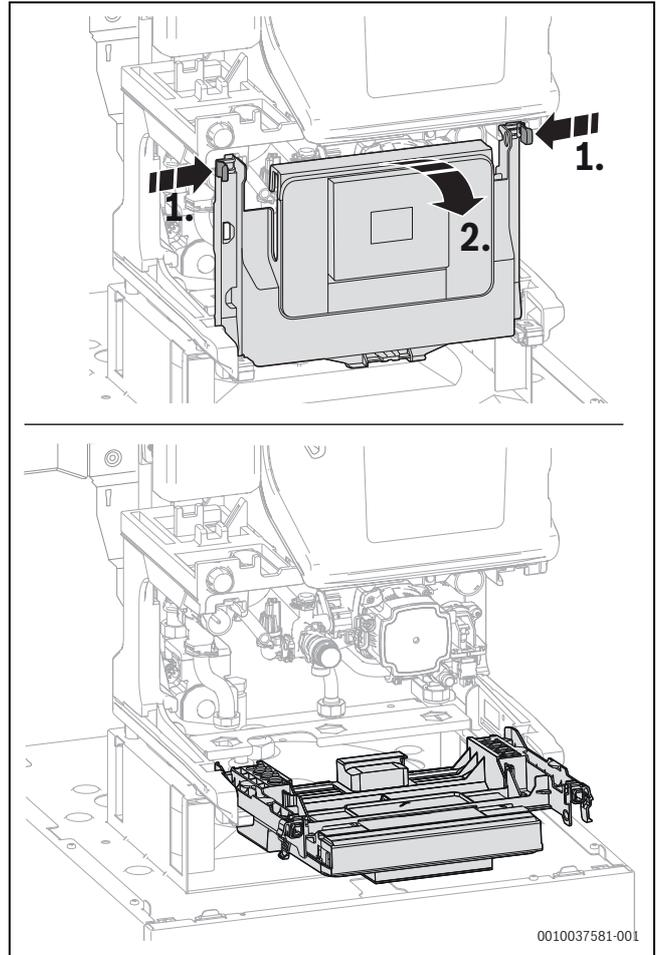
Bild 120 Steuergerät herunterklappen
