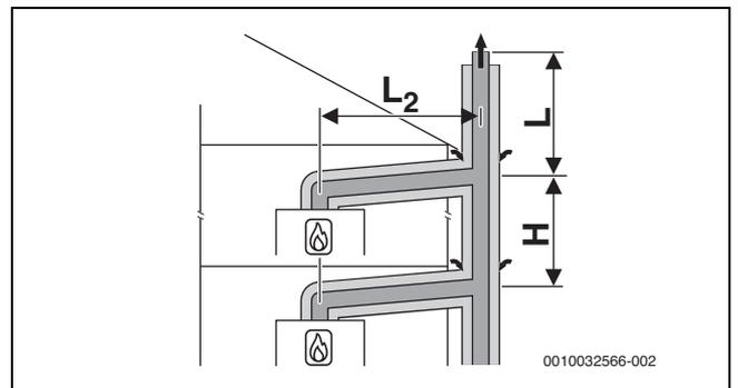
Bild 43 Mehrfachbelegung nach C<sub>(13)3x</sub> mit konzentrischer Luft-Abgas-Führung an der Außenwand und im Aufstellraum
