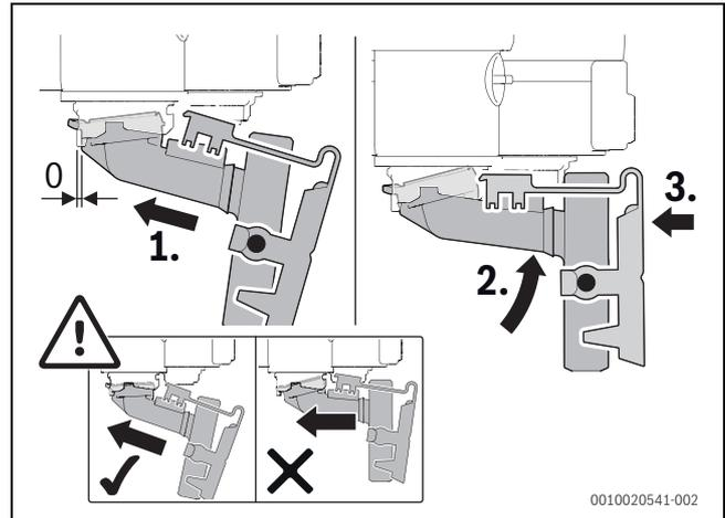
Bild 156 Kondensatsiphon einbauen
