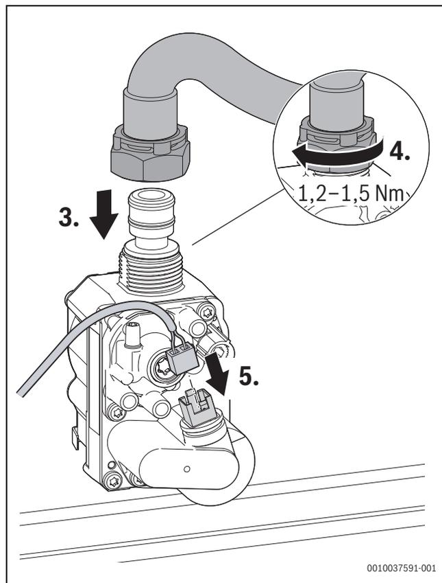
Bild 151 Gasschlauch und Stecker anschließen – Anzugsdrehmoment beachten
