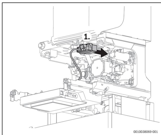
Bild 69 Funkmodul-Halter auf die Rückseite des Geräts führen
