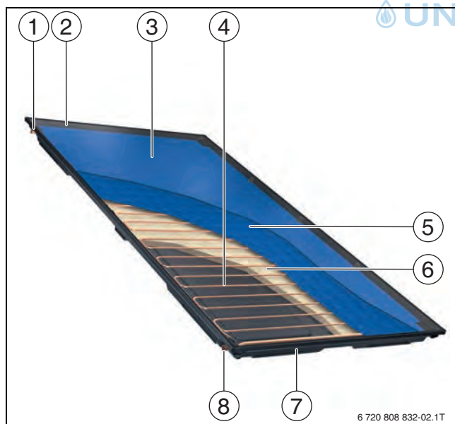
Bild 7 Aufbau Logasol SKT1.0; Abmessungen und technische Daten → Seite 9
