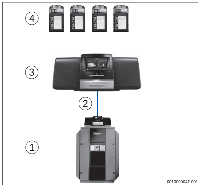
Bild 36 Regelgerät Logamatic 5311 für Heizkessel mit Anbaubrenner
