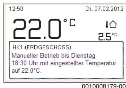
Ein Pop-up-Fenster mit der aktuellen gewünschten Raumtemperatur wird angezeigt. Wenn der manuelle Betrieb mit begrenzter Dauer aktiv ist, wird zusätzlich angezeigt, wann der manuelle Betrieb beendet wird.
