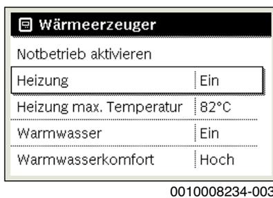
Um die maximale Vorlauftemperatur für die Heizung einzustellen:
