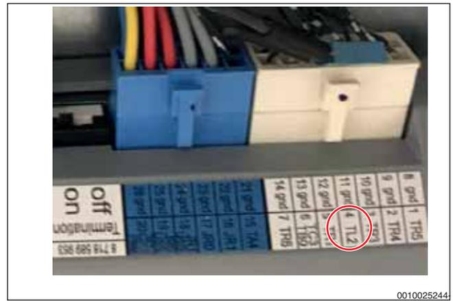
Bild 15 Referenzfühler TL2 an der I/O-Modul-Platine
