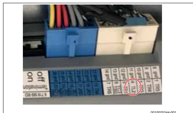
Bild 15 Referenzfühler TL2 an der I/O-Modul-Platine
