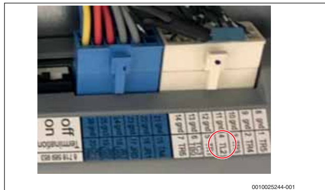
Bild 14 Referenzfühler TL2 an der I/O-Modul-Platine
