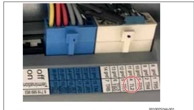
Bild 10 Referenzfühler TL2 an der I/O-Modul-Platine
