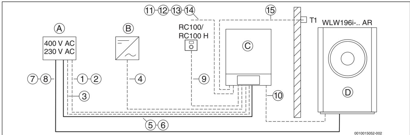
Bild 13 Kabelzugplan der elektrische Leitungen bei Außenaufstellung (Prinzipdarstellung)
