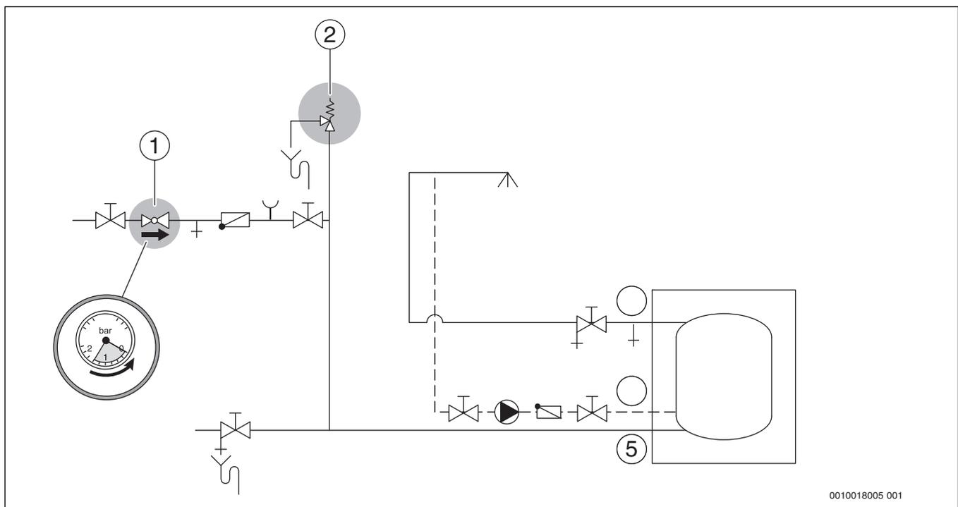
Bild 9 Hydraulischer Anschluss des Warmwasserspeichers
