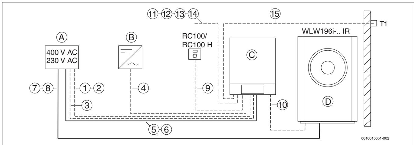
Bild 14 Kabelzugplan der elektrische Leitungen bei Innenaufstellung (Prinzipdarstellung)
