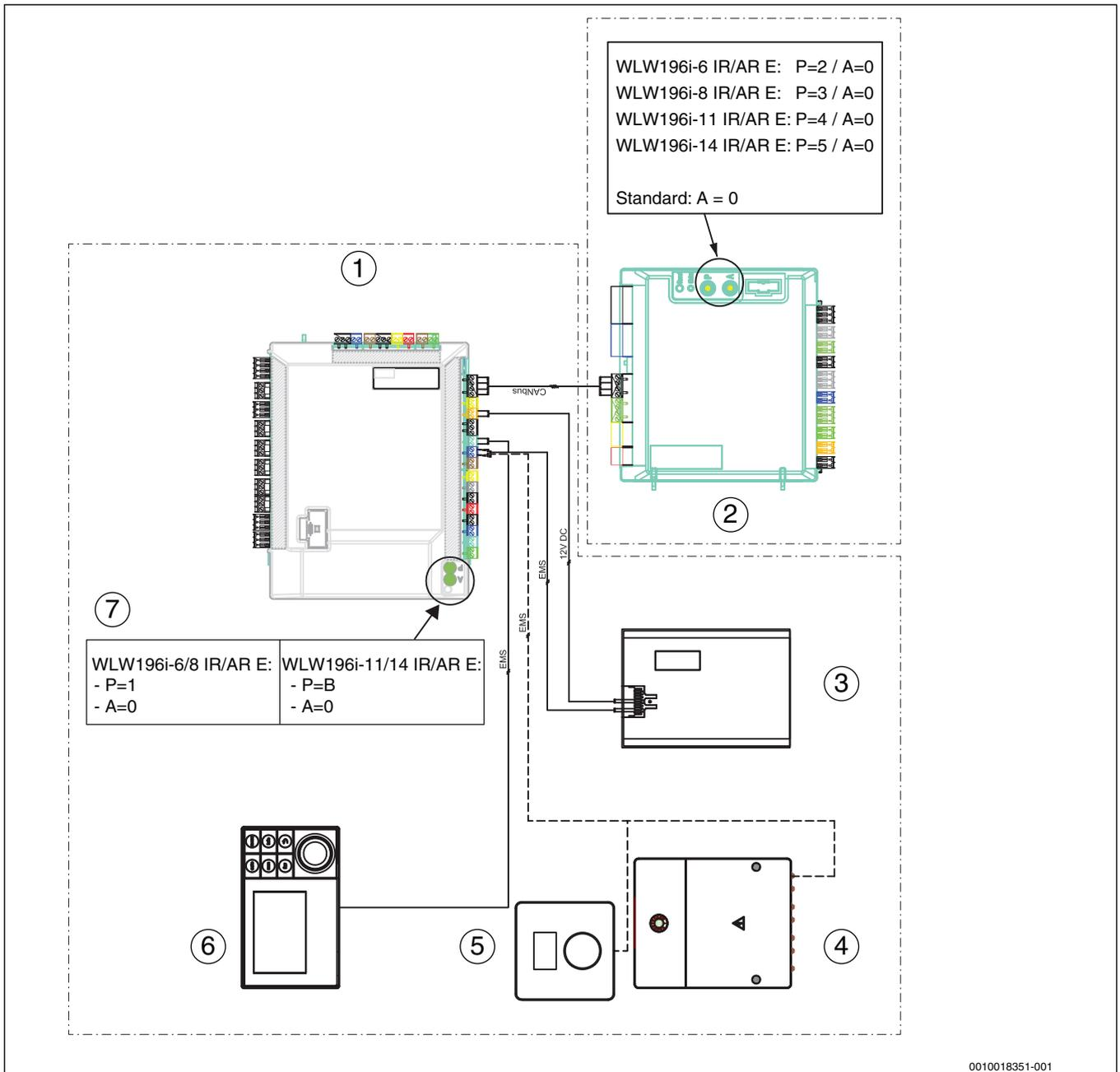
Bild 12 Kreisschema Wärmepumpenmodule
