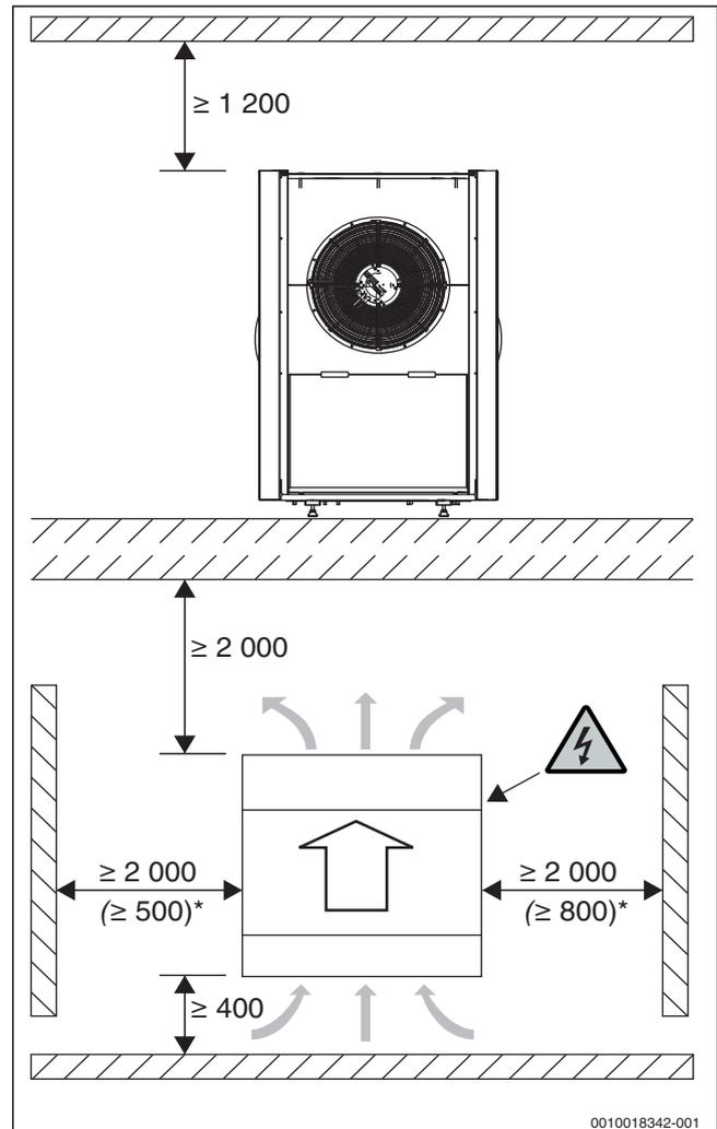
Bild 4 Mindestabstände der Außeneinheit (Maße in mm)
