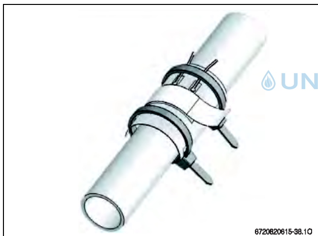
Bild 27 Montage des Taupunktfühlers (Beispiel)
