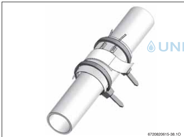
Bild 27 Montage des Taupunktfühlers (Beispiel)
