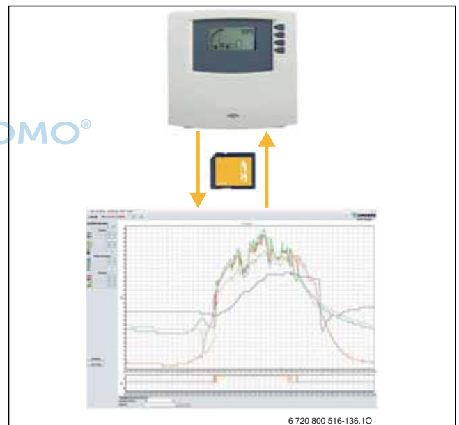
Bild 66 BS 500 im Datenaustausch per SD-Karte mit kostenloser Junkers Datenlogger-Software
