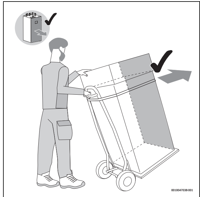
Bild 9 Inneneinheit mit einer Sackkarre transportieren
