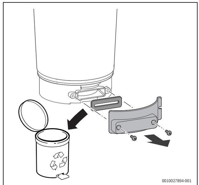
Bild 67 Prüfoffnung öffnen
