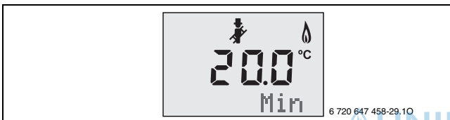
Bild 47 Min (= minimale Nennwärmeleistung) blinkt
