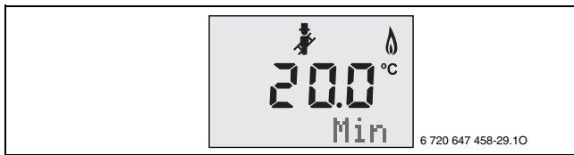
Bild 35 Min (= minimale Nennwärmeleistung) blinkt
