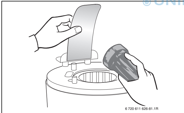
Bild 65 Wärmeblock auf Rückstände prüfen
