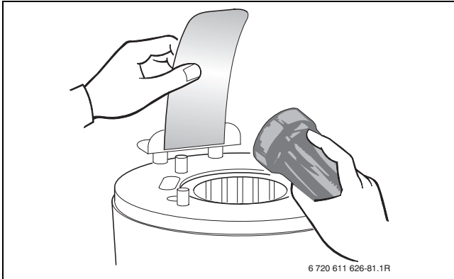
Bild 64 Wärmeblock auf Rückstände prüfen
