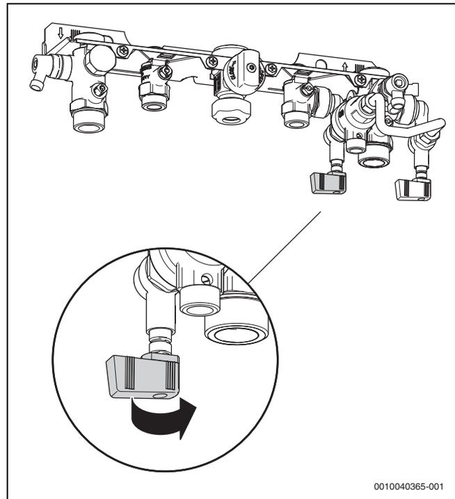
Bild 7 Füllleinrichtung öffnen
