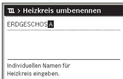
Das ausgewählte Zeichen wird eingegeben (eingefügt). Das Eingabefeld für die nächste Stelle im Text wird aktiviert.
