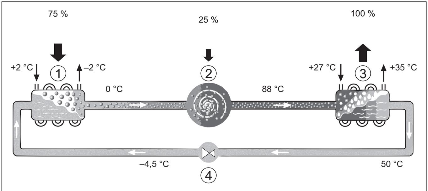
Bild 2 Funktionsprinzip des Kältemittelkreises in der Wärmepumpe
