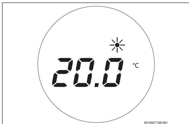
Bild 2 Beispiel in der Betriebsart Heizbetrieb
