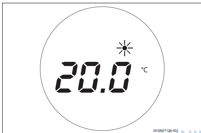
Fig. 2 Ejemplo en el funcionamiento de la calefacción
