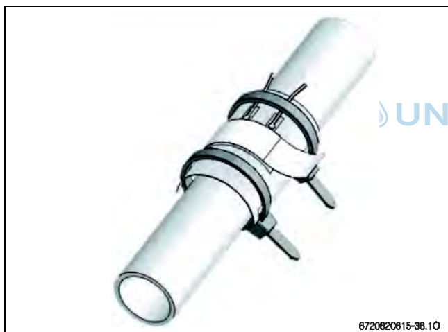
Bild 27 Montage des Taupunktfühlers (Beispiel)
