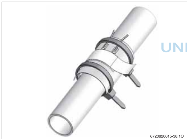
Bild 27 Montage des Taupunktfühlers (Beispiel)
