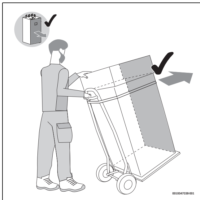
Bild 9 Inneneinheit mit einer Sackkarre transportieren
