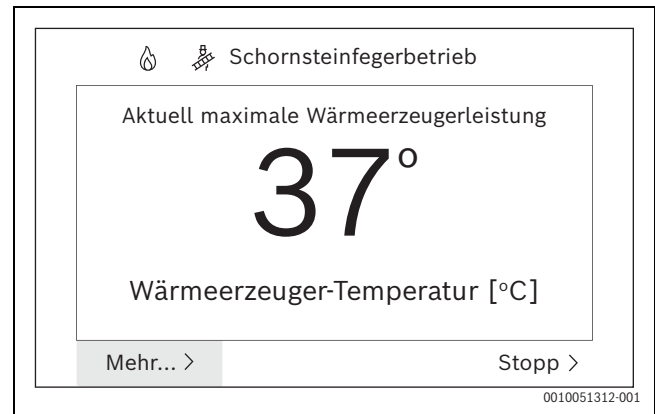
Bild 53 Abgastest aktiv (Beispiel)
