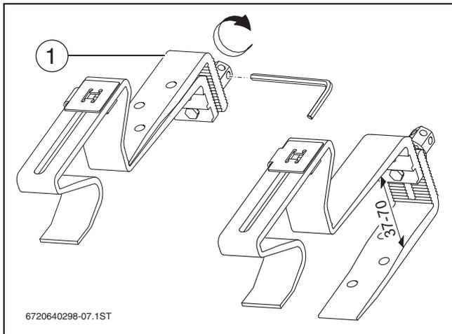
Bild 22 Dachhaken-Unterteil drehen, Maße in mm
