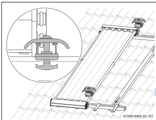
Bild 52 Kollektorspanner einlegen
