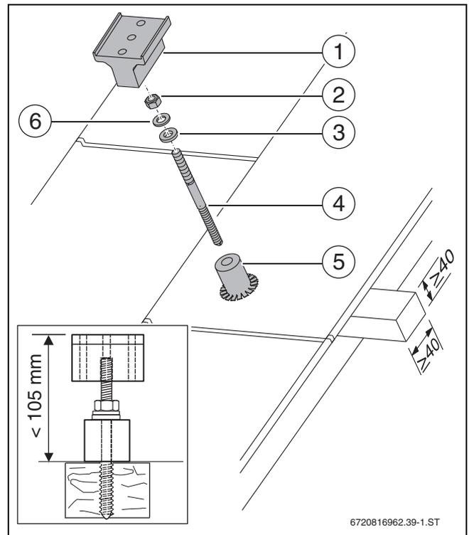
Bild 34 Stockschraube montieren
