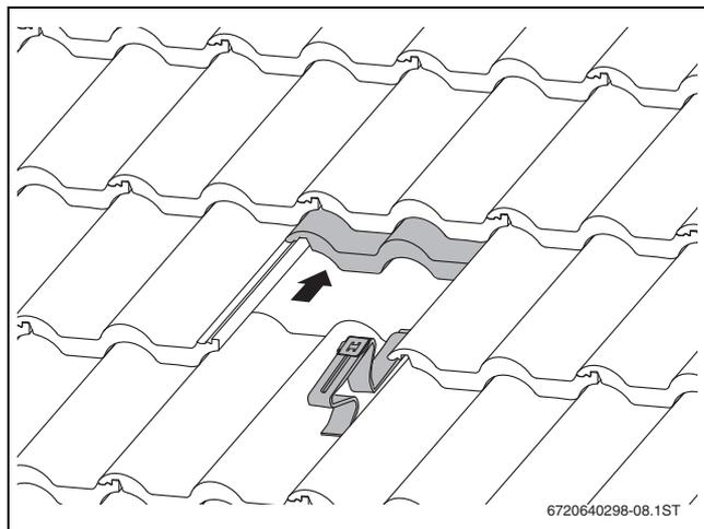
Bild 23 Eingehängter Dachhaken
