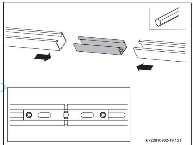
Bild 42 Profilschienen verbinden
