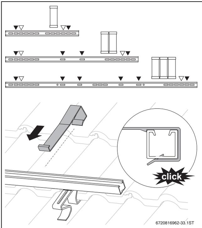
Bild 45 Abrutschsicherungen montieren (weiße Dreiecke = alternative Positionen)
