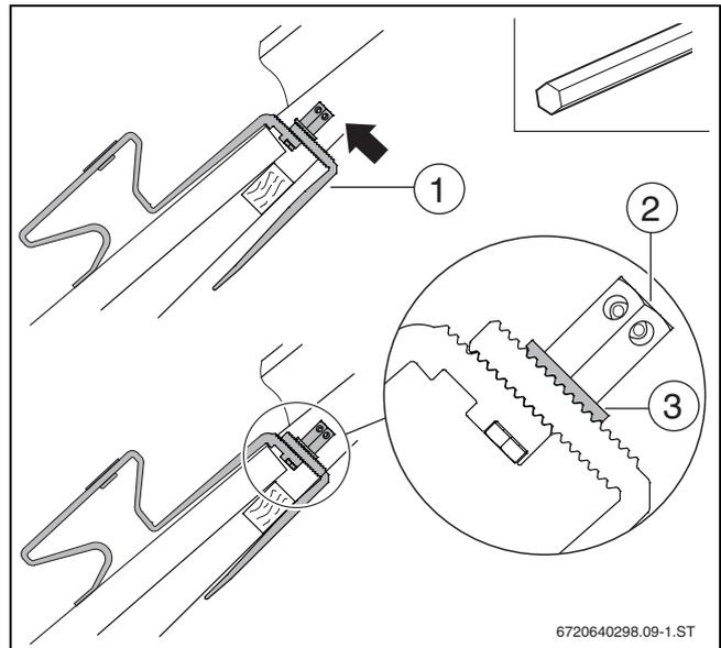
Bild 24 Dachhaken montieren
