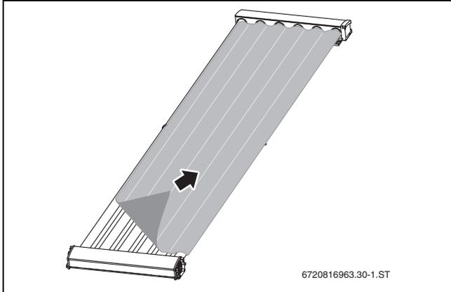
Bild 64 Kollektorfolie entfernen
