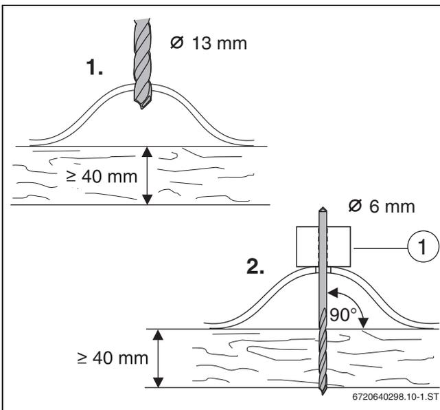
Bild 36 Vorbohren
