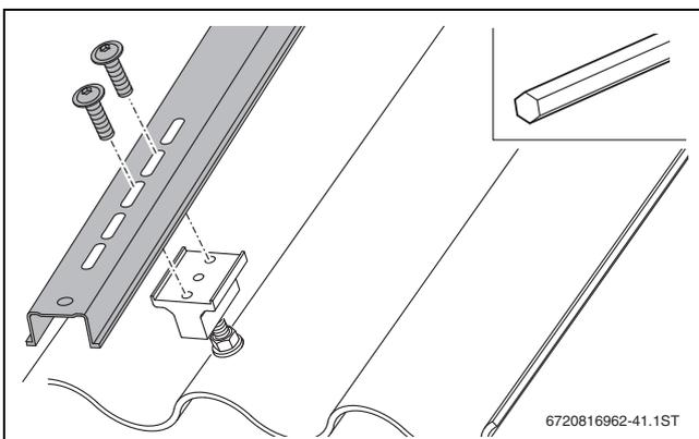
Bild 40 Mit Haltebock: Profilschiene mit 2 Schrauben befestigen
