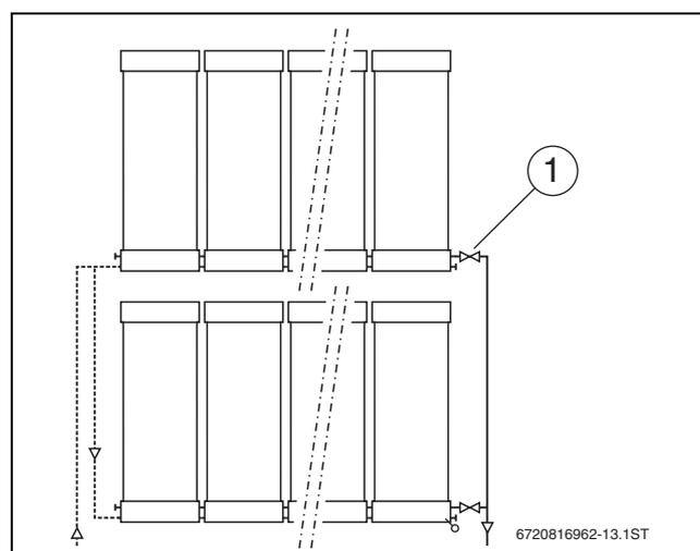
Bild 16 Maximal 14 Kollektoren je Reihe (Parallelschaltung nach Tichelmann)
