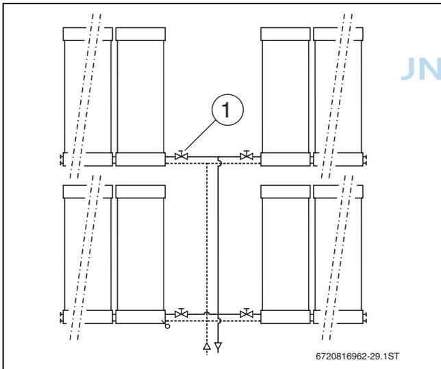
Bild 18 Maximal 7 Kollektoren je Einzelfeld (Parallelschaltung)
