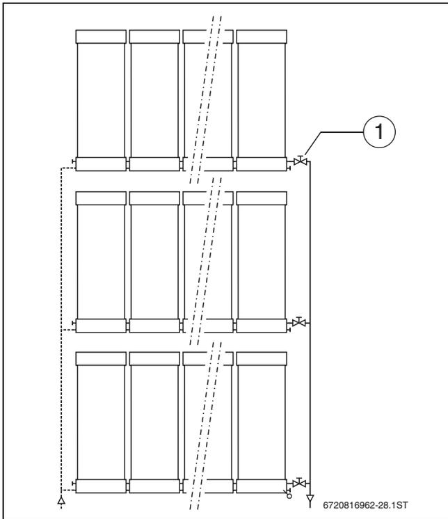
Bild 17 Maximal 14 Kollektoren je Reihe (Parallelschaltung)
