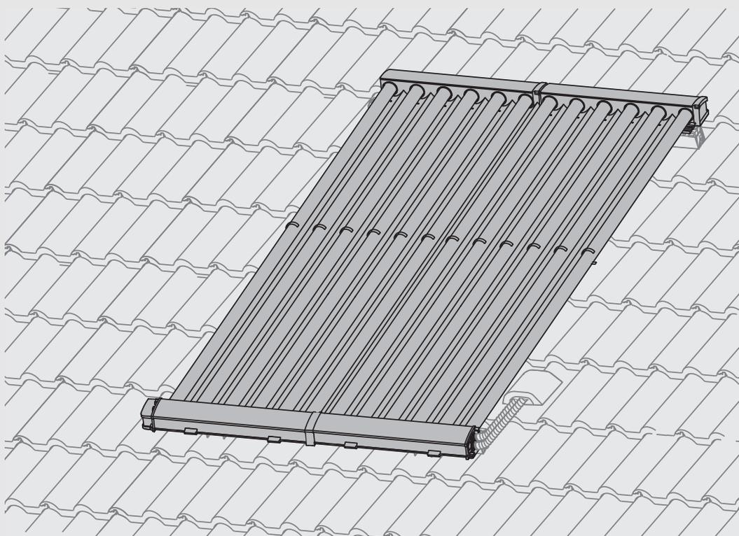
Vakuumpöhrnkollektor für solarthermische Systeme
