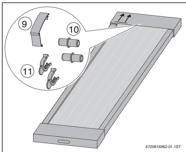
Bild 7 Kollektor und in der Verpackung liegende Einzelteile
