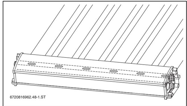
Bild 65 Entwässerungslöcher im Kollektorprofil müssen frei sein
