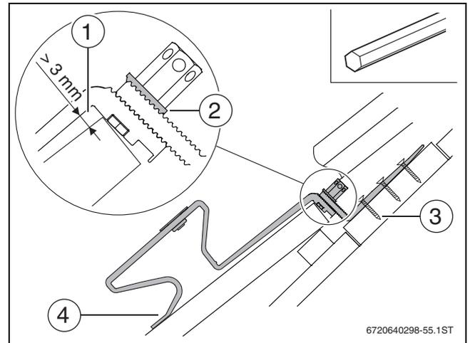
Bild 28 Dachhaken befestigen
