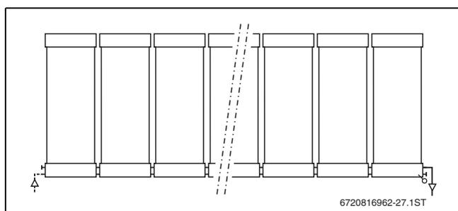
Bild 13 Maximal 14 Kollektoren, wechselseitiger Anschluss (1 Reihe)
