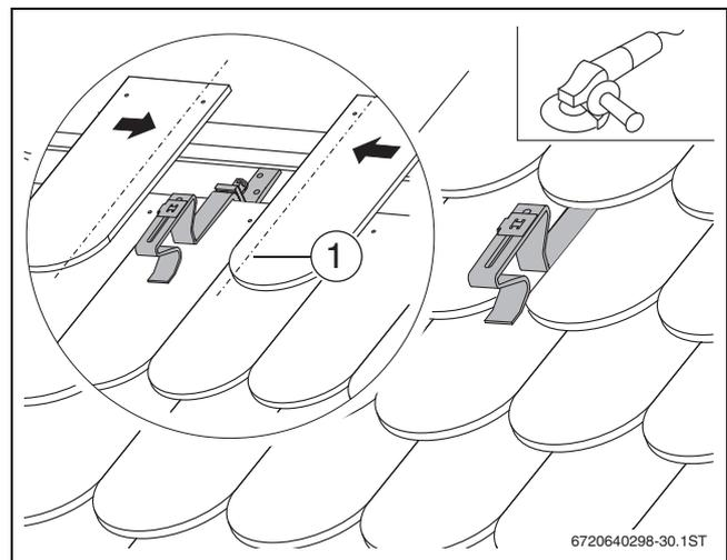
Bild 32 Biberschwanzziegel zuschneiden
