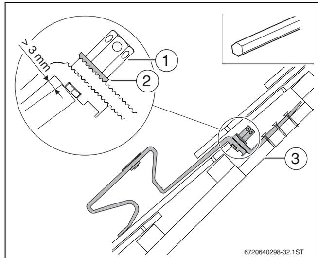
Bild 31 Dachhaken montieren
