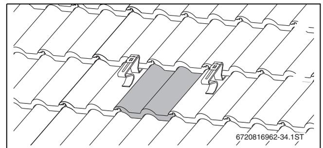
Bild 20 Mindestens einen unbelasteten Dachziegel zwischen zwei Dachhaken nebeneinander
