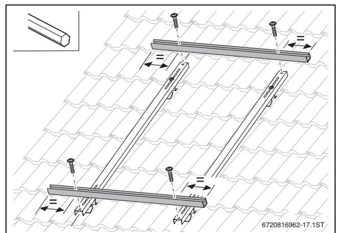
Bild 43 Profilschienen mit Schraube und Nietmutter verbinden
