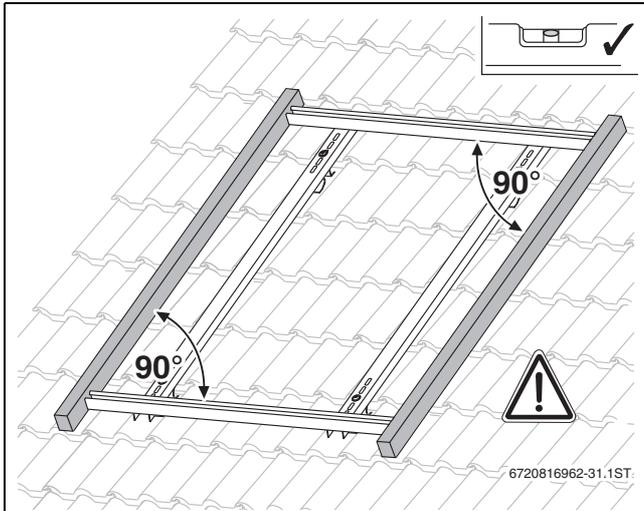
Bild 44 Profilschienen ausrichten
