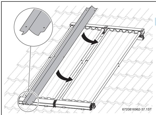
Bild 61 Zwischenspiegel einlegen
