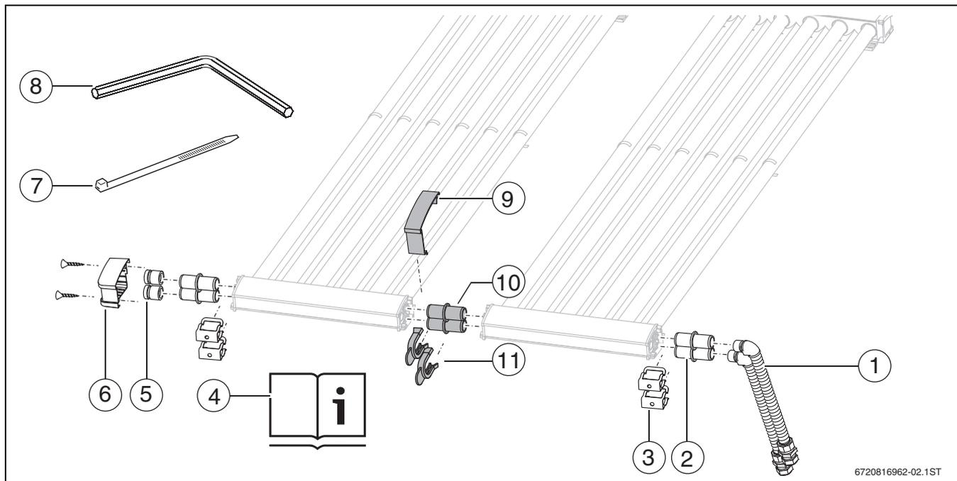
Bild 6 1 Anschluss-Set Aufdach und 2 Verbindungs-Sets
