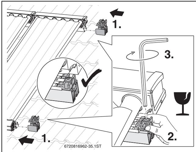
Bild 56 Kollektorspanner montieren
