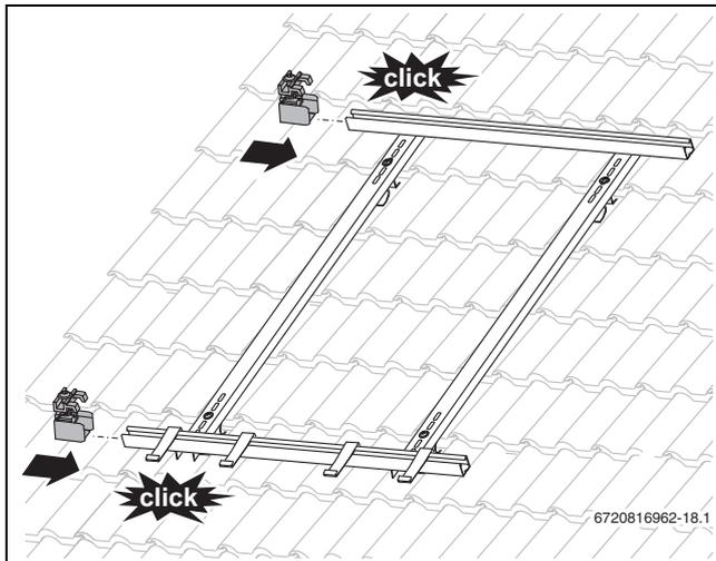
Bild 47 Kollektorspanner montieren
