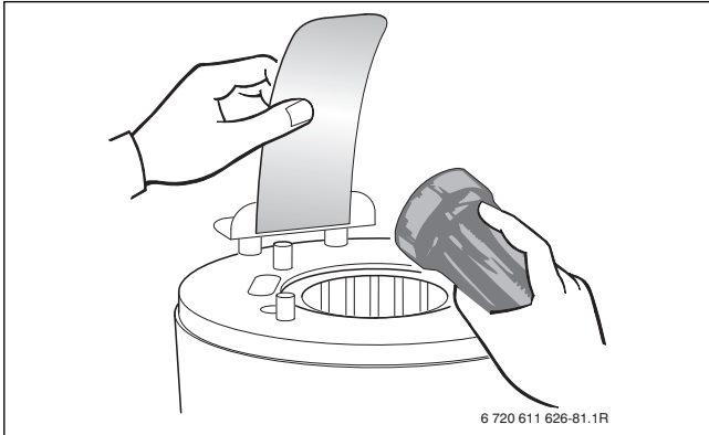
Bild 92 Wärmeblock auf Rückstände prüfen
