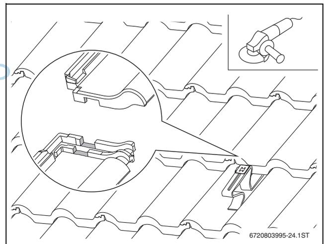
Bild 25 Profilierte Dachziegel
