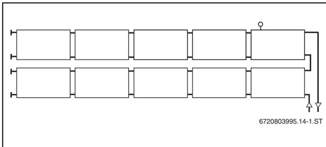
Bild 15 Gleichseitiger Anschluss waagerechter Kollektoren (2 Reihen)
