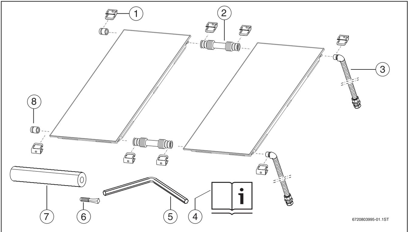
Bild 6 1 Anschluss-Set Aufdach und 2 Verbindungs-Sets
