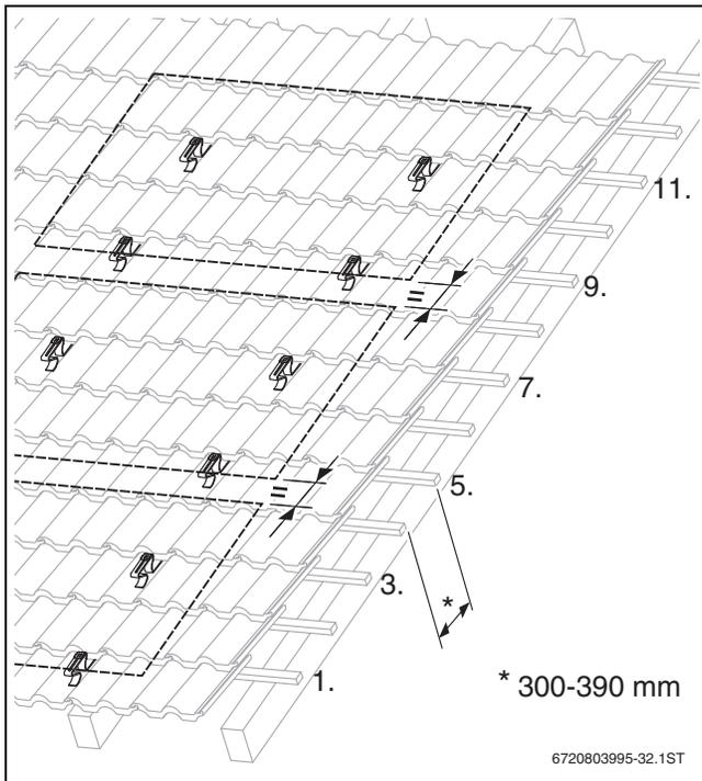
Bild 20 Abstände der Dachhaken bei 3 waagerechten Kollektoren
