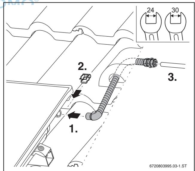
Bild 59 Anschlussrohr (Vorlauf) durch das Dach führen
