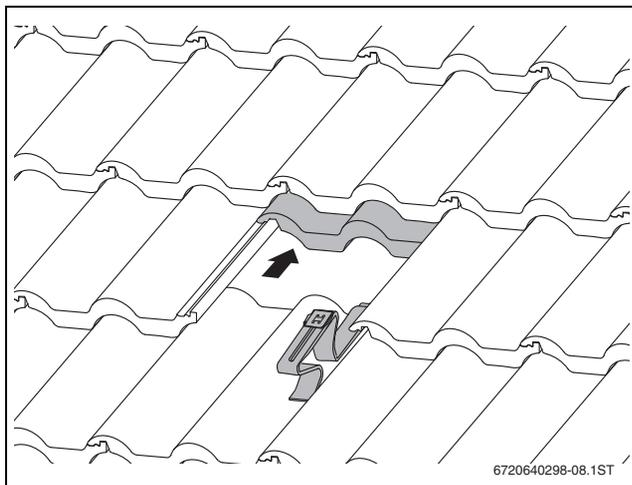
Bild 23 Einghängter Dachhaken
