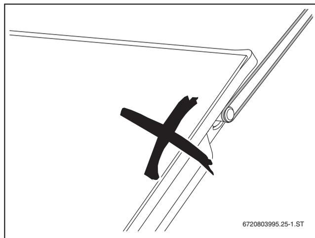
Bild 8 Kollektoranschlüsse nicht als Transporthilfe nutzen
