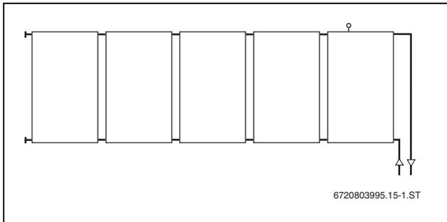
Bild 14 Gleichseitiger Anschluss rechts oder links (1 Reihe)
