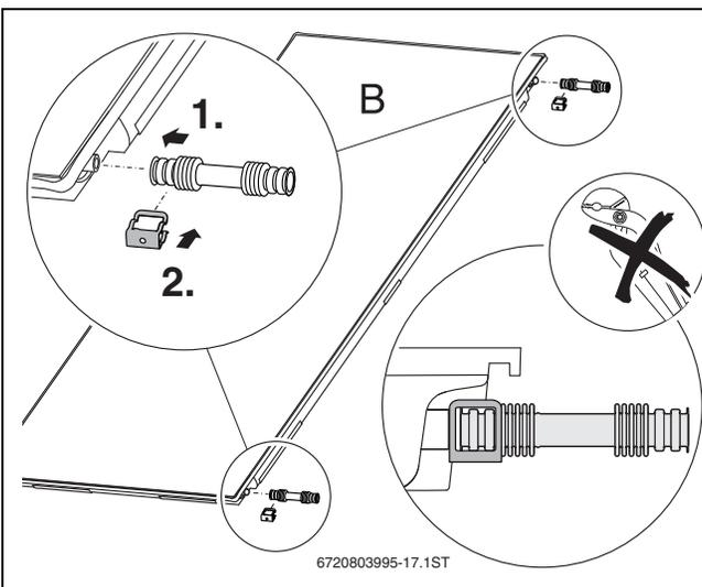
Bild 47 Verbindungs-Set am zweiten und allen weiteren Kollektoren
