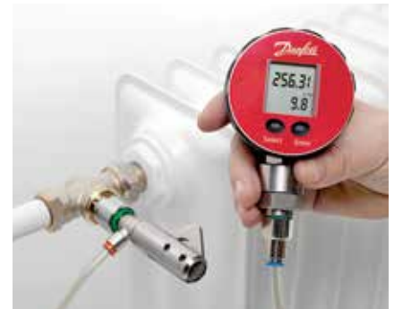
Der Abgleich eines Heizkörpers mit dem Danfoss dP tool™.
