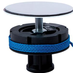
Der Mittelfuß wird nach der Montage des Rahmens und der Duschwanne durch das blaue Zugseil in seiner Höhe justiert.
