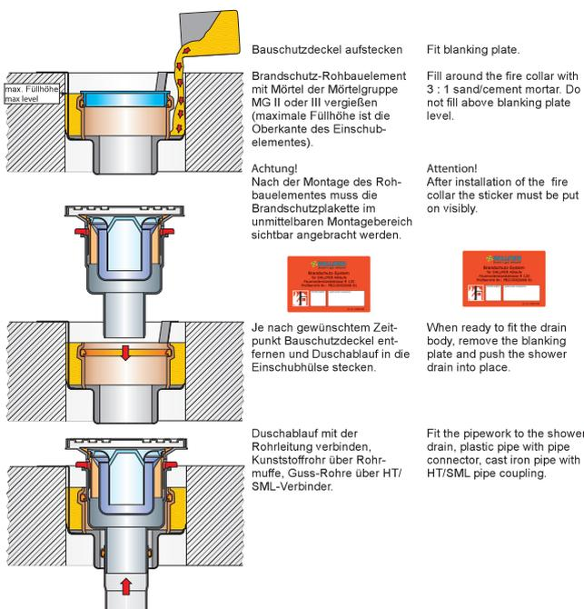
Einbauvarianten / Alternative methods
