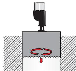
Kernbohrung Ø140/150mm (Ø138-158 mm) durchführen, oder Schutzfüllung (Styropor) aus Durchbruch entfernen.
