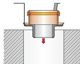
Brandschutz-Rohbauelement einschieben, bis die Haltebügel aufliegen.
