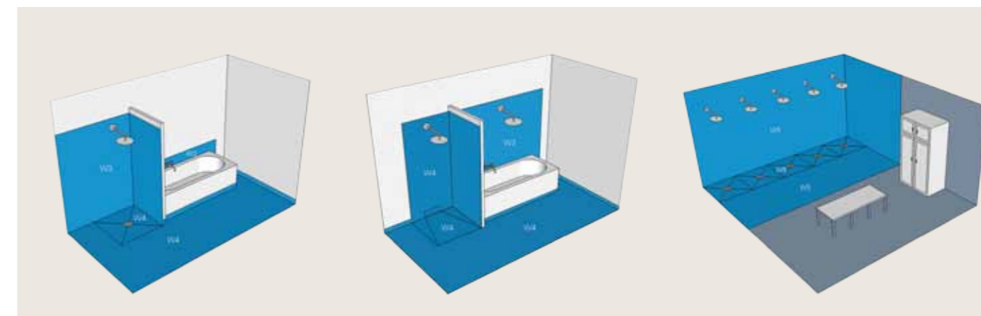
Abb. 1: Abdichtung bei mäßiger Beanspruchung. Dusche ohne Kabine.
