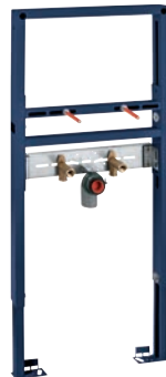
39 052 000 Rapid SL für Waschtisch höhenverstellbar für Einlochbatterie mit 2 schallgedämmten Armaturenanschlüssen 1,13 m Bauhöhe
