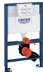
39 140 000 Rapid SL für Wand-WC - Barrierefrei Spülkasten GD 2 mit Befestigungselement für Haltegriffe für WC-Becken mit bis zu 70 cm Ausladung 1,13 m Bauhöhe
