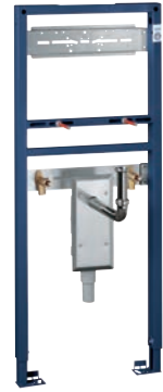
38 625 001 Rapid SL für Waschtisch - Barrierefrei für Einloch- oder Wandbatterie mit 2 schallgedämmten Armaturenanschlüssen mit UP-Geruchverschluss und verstellbarem Ablaufbogen 1,13 m Bauhöhe
