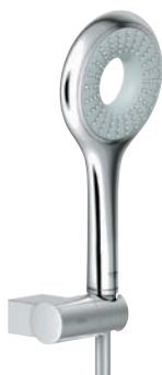
27 381 000 Rainshower Icon 100 Wandhalterset 1 Strahlart Wandbrausehalter verstellbar mit 9.5 l/min. GROHE EcoJoy®
