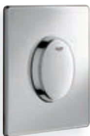
38 564 000 Skate Air Abdeckplatte für 1-Mengen-Betätigung oder Start/Stopp-Betätigung, senkrechte Montage 156 x 197 mm für pneumatisches Ablaufventil, chrom, GGT-Siegel „GUT“
