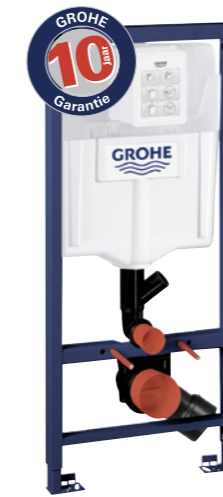
39 002 000 Rapid SL für WC mit Spülkasten GD2, Start/Stopp oder 2-Mengen (6 l / 3 l), Vorwand- oder Ständerwandmontage, Bauhöhe 1,13 m mit Spülrohr für externe Geruchsabsaugung
