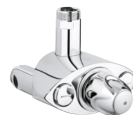
35 085 000 Grohtherm XL Thermostat-Batterie, DN 25, Wandmontage, Temperatur- wählgriff mit voreinstellbarem Sicherheitsendanschlag, Anschlussgewinde 1 1/4" Abgangsgewinde 1 1/2"
