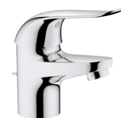
32 763 000 Euroeco Spezial Einhand-Waschtischbatterie, DN 15, variabel einstellbare Mengenbegrenzung, Laminarstrahlregler 9l/min., Metallhebel 120 mm, Temperaturbegrenzer, Zugstangen-Ablaufgarnitur
