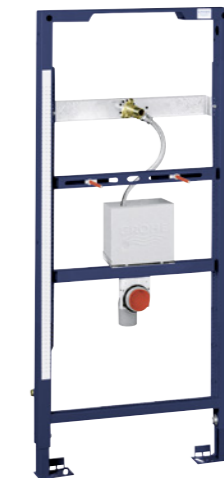
39 376 000 Rapid SL für Urinal mit Rohbau-Set für Temperatursensor, Vorwand- oder Ständerwandmontage 1,13 m und 1,30 m Bauhöhe
