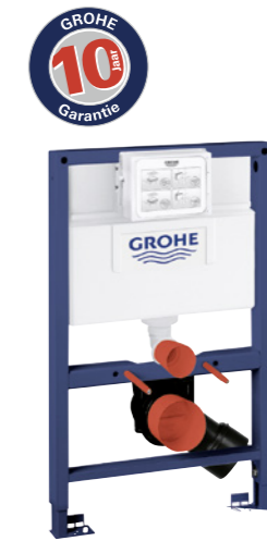
38 526 000 Rapid SL für WC mit Spülkasten 6 - 9 l, Start/Stopp oder 2-Mengen (6 l / 3 l), Vorwand- oder Ständerwandmontage, Bauhöhe 0,82 m
