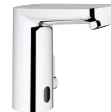
36 325 001 Eurosmart CE Infrarot-Elektronik für Waschtisch mit Mischung, Steckertrafo 230 V thermische Desinfektion
