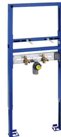
39 052 000 Rapid SL für Waschtisch, höhenverstellbar für Einlochbatterie, 1,13 m inkl. 2 schallgedämmter Armaturenanschlüsse
