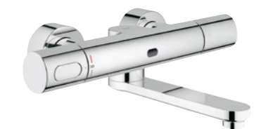
36 333 000 Eurosmart CE Infrarot-Elektronik für Waschtisch mit Thermostat, Lithium-Batterie 6 V thermische Desinfektion, schwenkbarer Auslauf, Ausladung 287 mm
