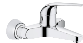
32 778 000 Euroeco Spezial Einhand-Waschtischbatterie, DN 15, Wandmontage, variabel einstellbare Mengenbegrenzung, Ausladung 205 mm, Laminarstrahlregler 9l/min, Metallhebel 170 mm, Temperaturbegrenzer
