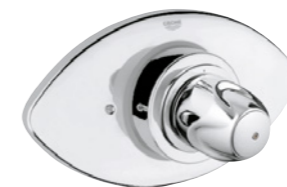
35 003 000 Grohtherm XL Thermostat-Batterie, 1", UP-Montage, Temperatur- wählgriff mit voreinstellbarem Sicherheitsendanschlag, Anschlussgewinde 1 1/4" Abgangsgewinde 1 1/4"
