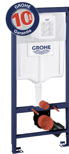
38 528 001 Rapid SL für WC mit Spülkasten GD2, Start/Stopp oder 2-Mengen (6 l / 3 l), Vorwand- oder Ständerwandmontage, Bauhöhe 1,13 m
