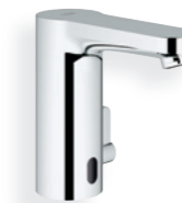
36 324 000 GROHE Eurosmart CE Infrarot-Elektronik, DN 15 für Waschtisch mit Mischung mit Stecker-Schaltnetzteil 100-230 V AC 50/60 Hz, 6 V DC für offene Warmwasserbereiter
