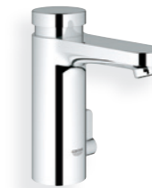
36 317 000 GROHE Eurosmart CT Selbstschluss-Waschtischbatterie mit Mischung Laufzeit 7 sec. (einstellbar auf 15 oder 30 sec.)
