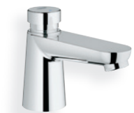
36 265 000 GROHE Euroeco CT Selbstschluss-Standventil, DN 15 Markierung blau/rot Laufzeit einstellbar auf 7, 15 und 30 sec.
