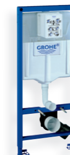
38 528 001 GROHE Rapid SL für WC mit Spülkasten GD2 Start/Stopp oder 2-Mengen (6 l / 3 l) Vorwand oder Ständerwandmontage Bauhöhe 1,13 m
