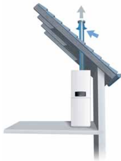
Raumluftunabhängige Aufstellvariante mit Rohr-in-Rohr-Kunststoff-Abgassystem
