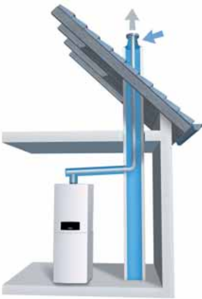
Raumluftunabhängige Aufstellvariante mit eingezogener Kunststoff-Abgasleitung im Schornstein (geeignet zur Luftansaugung)
