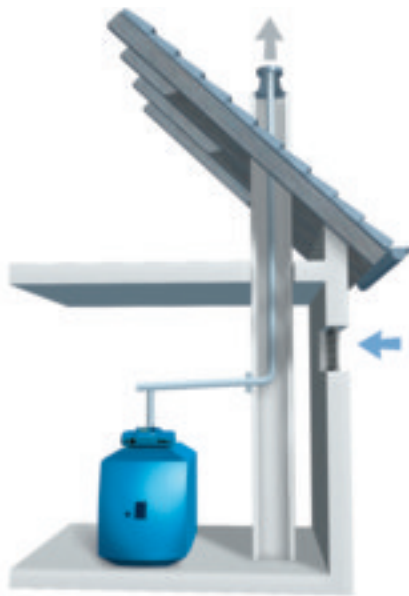
Raumluftabhängige Aufstellvariante mit eingezogenem Abgasrohr im Schornstein
