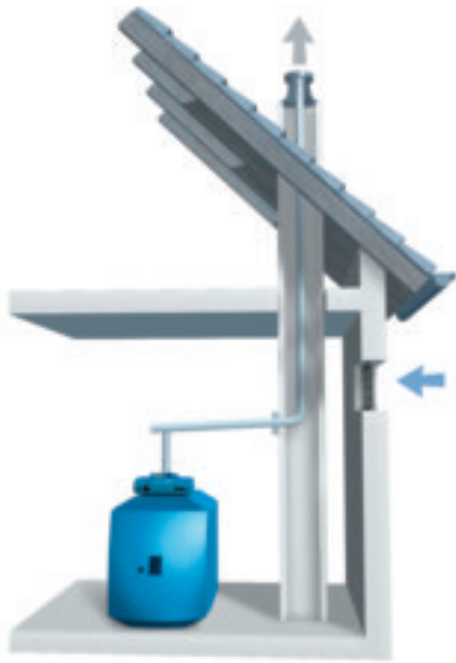
Raumluftabhängige Aufstellvariante mit eingezogenem Abgasrohr im Schornstein
