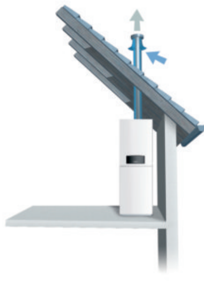
Raumluftunabhängige Aufstellvariante mit Rohr-in-Rohr-Kunststoff-Abgassystem
