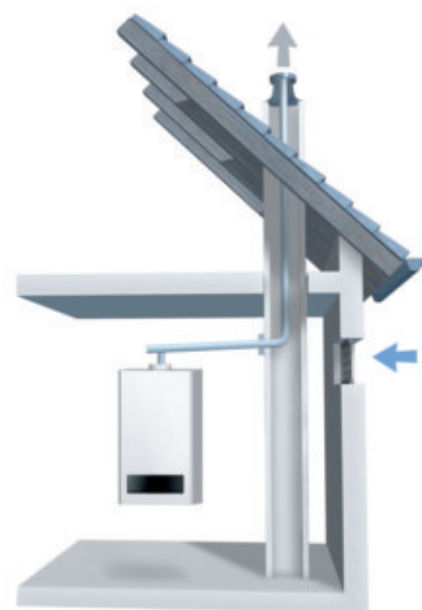
Raumluftabhängige Aufstellvariante mit eingezogenem Abgasrohr im Schornstein (Zuluft über Belüftungsöffnung)
