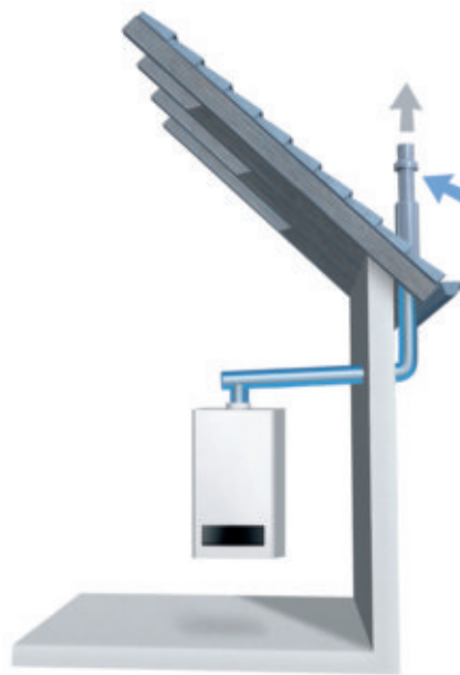
Raumluftunabhängige Aufstellvariante mit Rohr-in-Rohr-Kunststoff-Abgassystem
