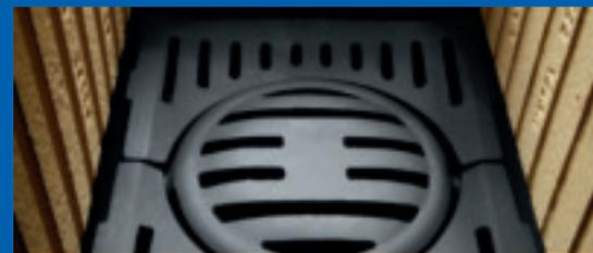
Da gibt's was dran zu rütteln: Durch den Rüttelrost lassen sich die Einsätze leicht reinigen und die Asche wird im darunterliegenden Aschekasten aufgefangen. Soll Holz als Brennstoff dienen, lässt sich der Rost leicht ausbauen und durch das Holzfeuerungsset aus Schamotte ersetzen.
