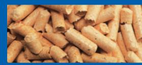
Pellets, die kleinen Kraftpakete aus Brennholz, Spänen und unbehandelten Abfallhölzern, werden unter hohem Druck zur normierten Größe zusammengepresst. Völlig ohne Bindemittel, aber mit hohem Brennwert.
