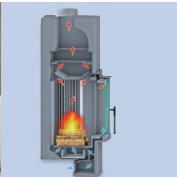
Optimale Verbrennungsluftzufuhr: Bei den Kamineinsätzen von Buderus kommt die Luft daher, wo sie am effektivsten genutzt werden kann – nämlich von unten.
