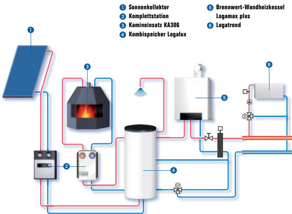
Kombinieren Sie die Kraft der Sonne mit Ihrem Kamineinsatz KA306. So lässt sich Wärme zur Trinkwassererwärmung und Heizungsunterstützung erzeugen.
