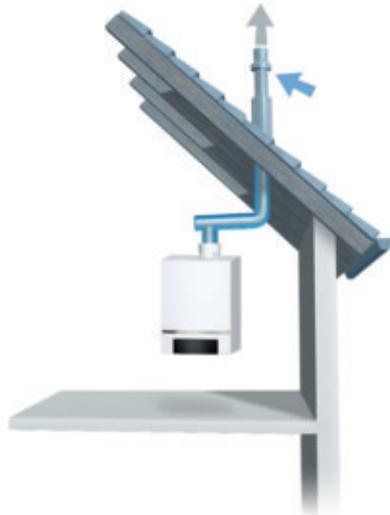
Raumluftunabhängige Aufstellvariante mit Rohr-in-Rohr-Kunststoff-Abgassystem
