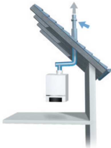
Raumluftunabhängige Aufstellvariante mit Rohr-in-Rohr-Kunststoff-Abgassystem
