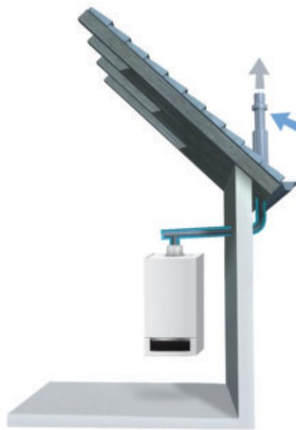
Raumluftunabhängige Aufstellvariante mit Rohr-in-Rohr-Kunststoff-Abgassystem (Außenfassade)
