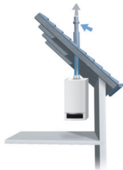
Raumluftunabhängige Aufstellvariante mit Abgasleitung über Dachinstallation
