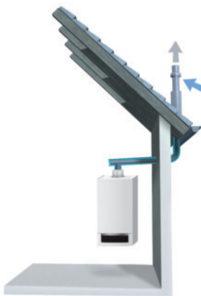
Raumluftunabhängige Aufstellvariante mit Rohr-in-Rohr-Kunststoff-Abgassystem (Außenfassade)
