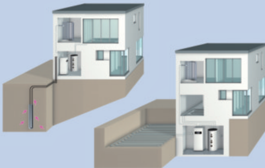
Logatherm WPS mit Erdwärmesonde (links) und Erdwärmekollektoren (rechts)
